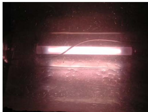
Fig. 4.5 – Fotografia de uma Lâmpada Operando em 40,1kHz.
