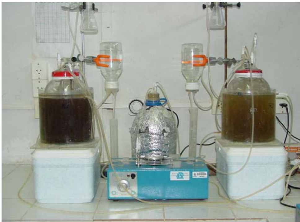
Figura 4.1: Sistema operacional para o estudo da remoção biológica de nitrogênio
