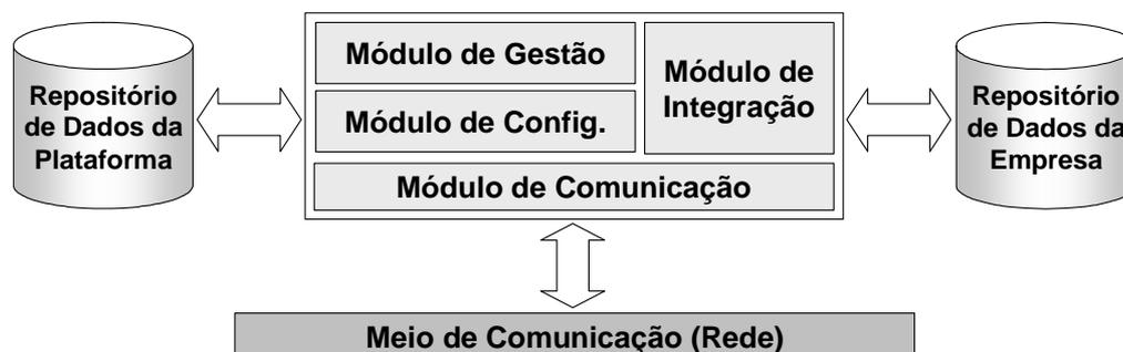
Figura 13: Arquitetura geral de uma plataforma para EVs.
