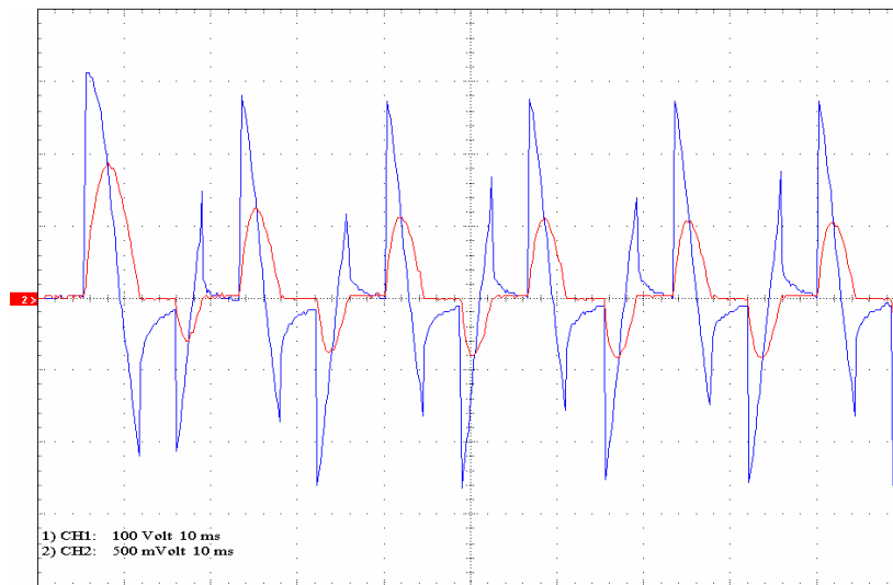
Figura 4.35 – Partida com gradador: Tensão (em azul) e corrente (em vermelho) medidos.
