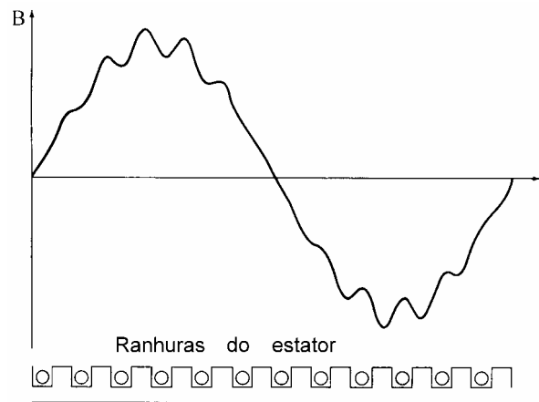
Figura 2.3 – Distribuição dos enrolamentos em ranhuras e força magnetomotriz.
