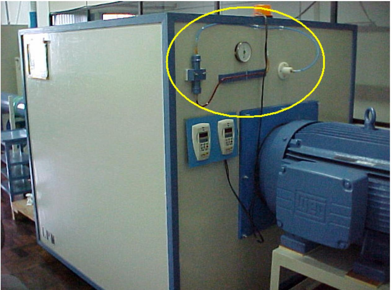
Figura 3.6 - Detalhe do ajuste de pressão da câmara de estabilização.
