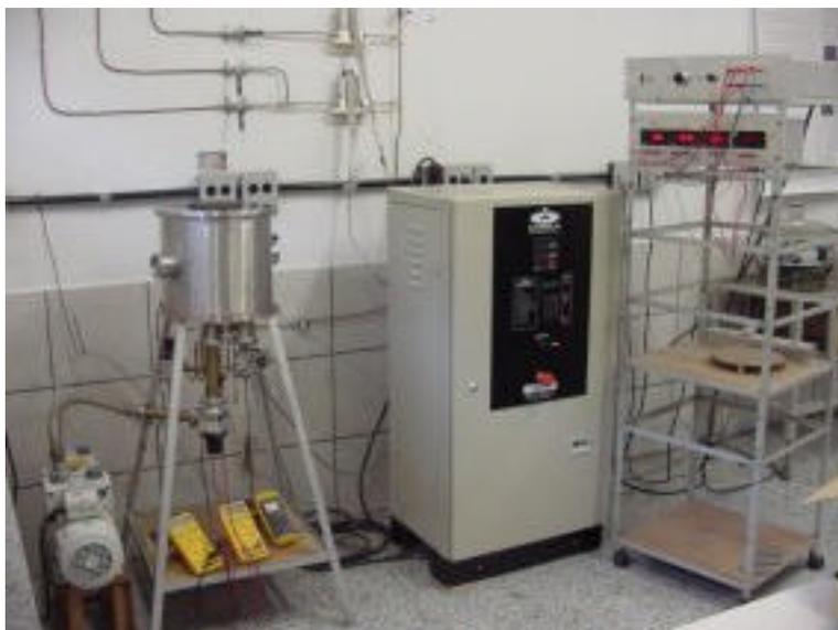
Figura 4.2 Fotografia do sistema para processamento de sinterização em reator de plasma
