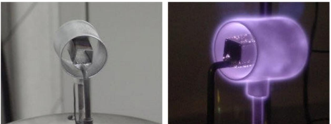
Figura 4.9 Fotografia da configuração forno-plasma montada, no reator de plasma: à esquerda (configuração desligada) e à direita (configuração com plasma).
