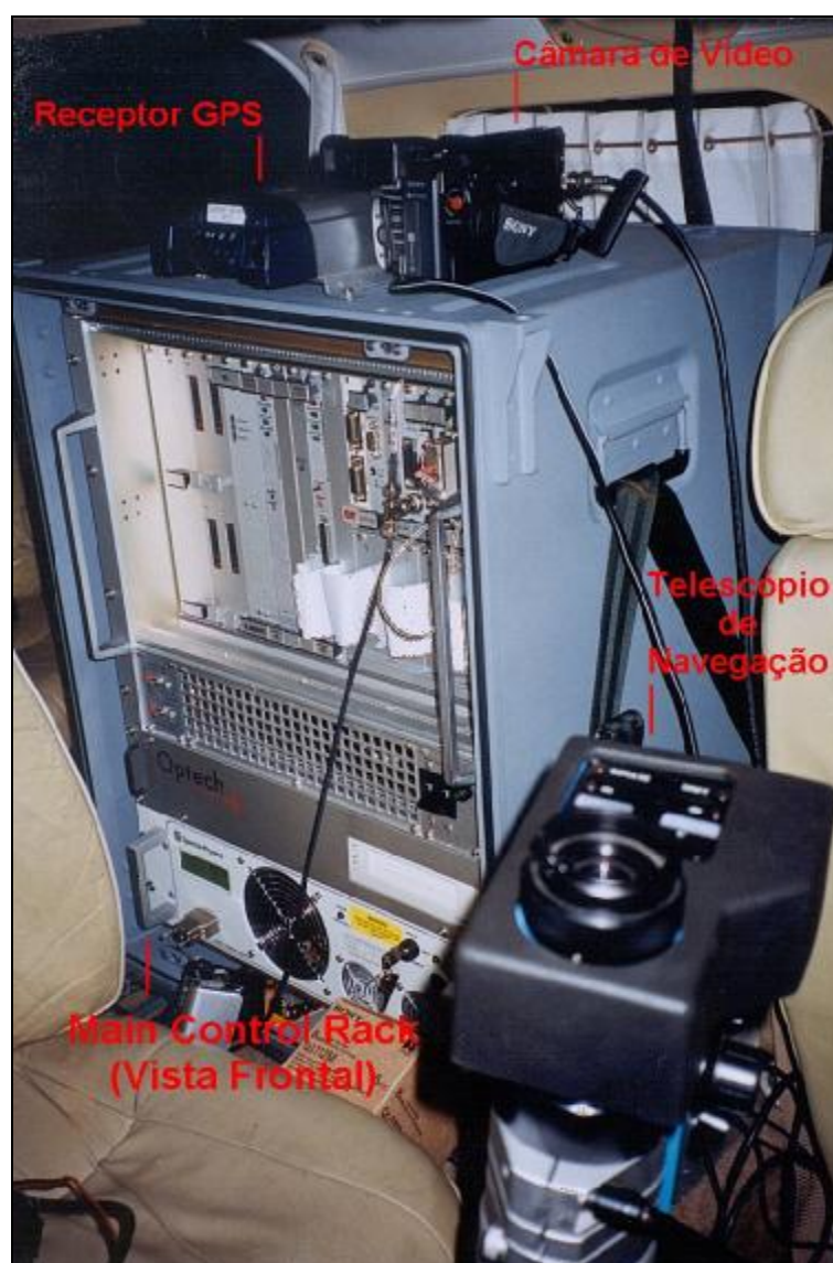
FIGURA 5.3 - ALTM 2025 - RECEPTOR GPS E CÂMARA DE VÍDEO
