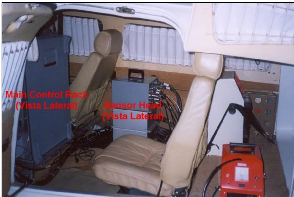
FIGURA 5.4 - ALTM 2025 - DISPOSIÇÃO NO INTERIOR DA AERONAVE
