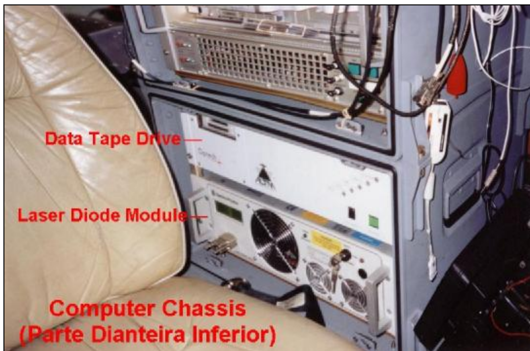
FIGURA 5.1 - ALTM 2025 - PARTE DIANTEIRA INFERIOR DO CONTROLE PRINCIPAL
