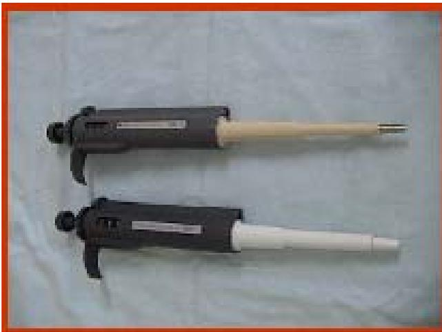
Figura 8 - Pipetas Eppendorf (para separação do plasma).
