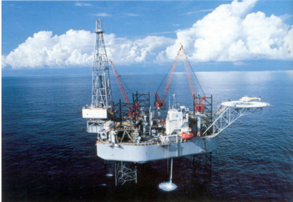
Figura 3 - Plataforma auto-elevável Fonte: Baker, 1985, p. 18.
