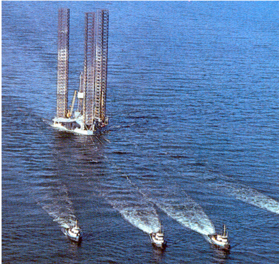
Figura 2 - Transporte de plataforma auto-elevável Fonte: Baker, 1985, p. 20.
