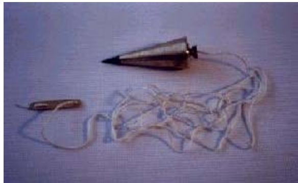
FIGURA 39: Prumo de centro usinado em latão com ponta de aço e cordão de nylon de 2mm de diâmetro.
