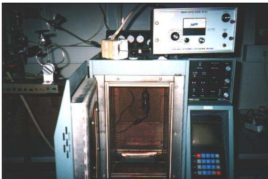
**Figura 4.8.** Foto do equipamento usado para as medidas das curvas de ruptura para as hidrotalcitas.
