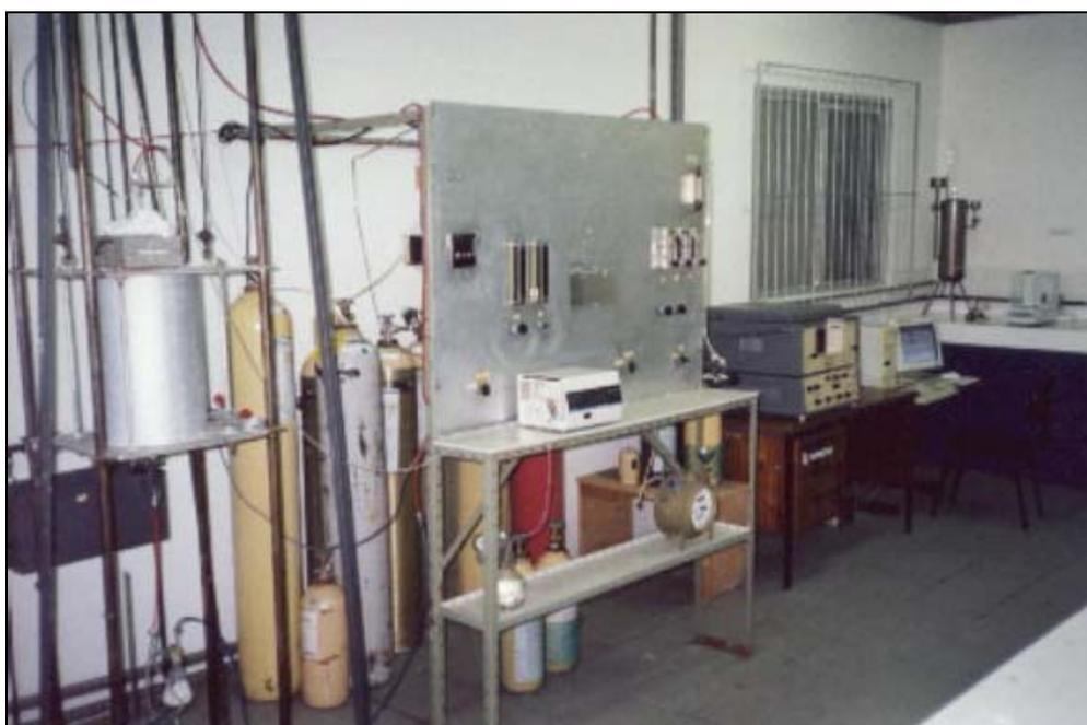
**Figura 4.11.** Foto da linha de reação para reforma de metano com vapor.
