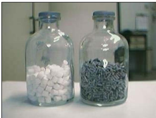
**Figura 4.1.** Foto das amostras de hidrotalcita virgem e catalisador usado.
