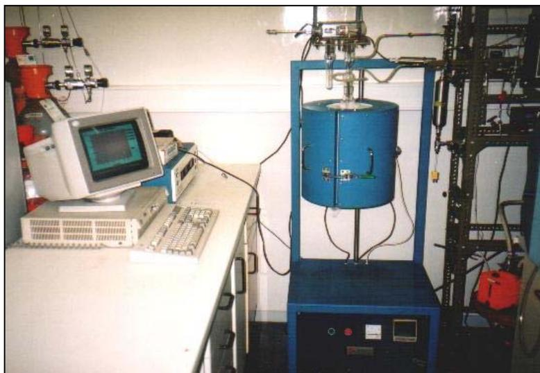
**Figura 4.4.** Foto do equipamento usado para as medidas microgravimétricas.
