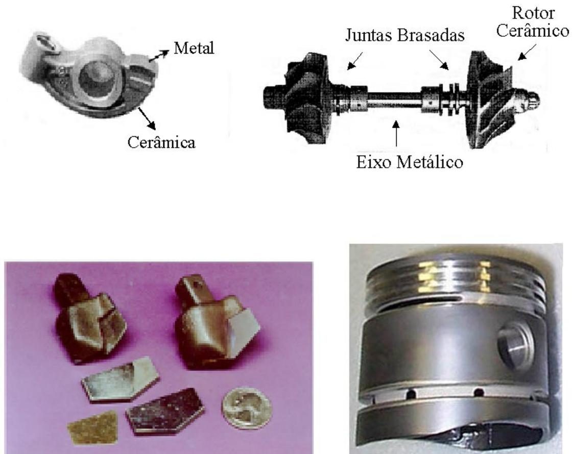
Figura 1: Exemplos de uniões entre metal e cerâmica.
