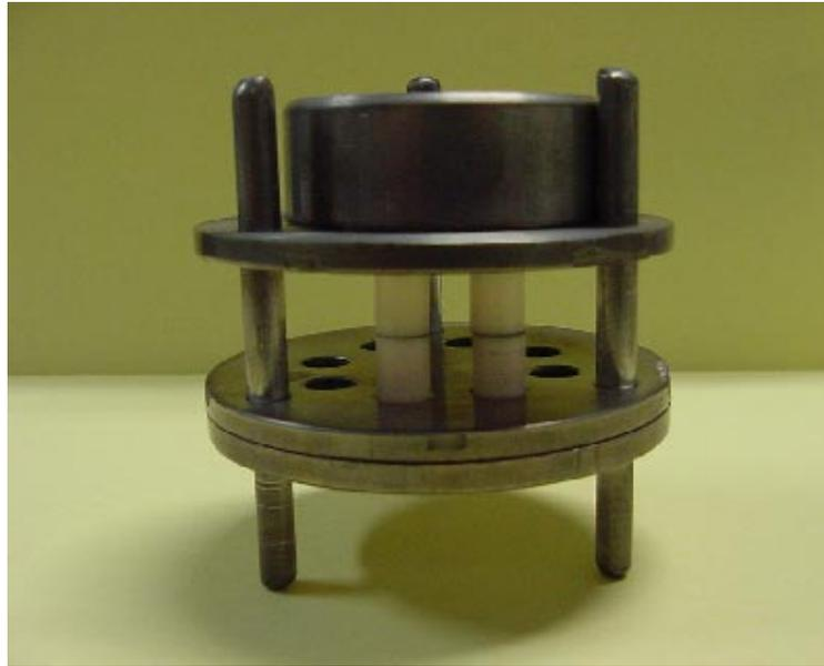
Figura 18: Dispositivo de brasagem.
