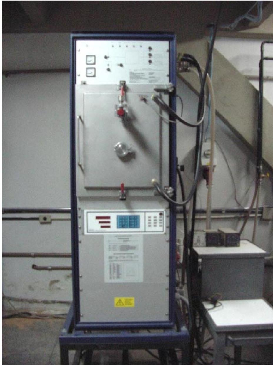
Figura 19: Forno resistivo à vácuo Gero.
