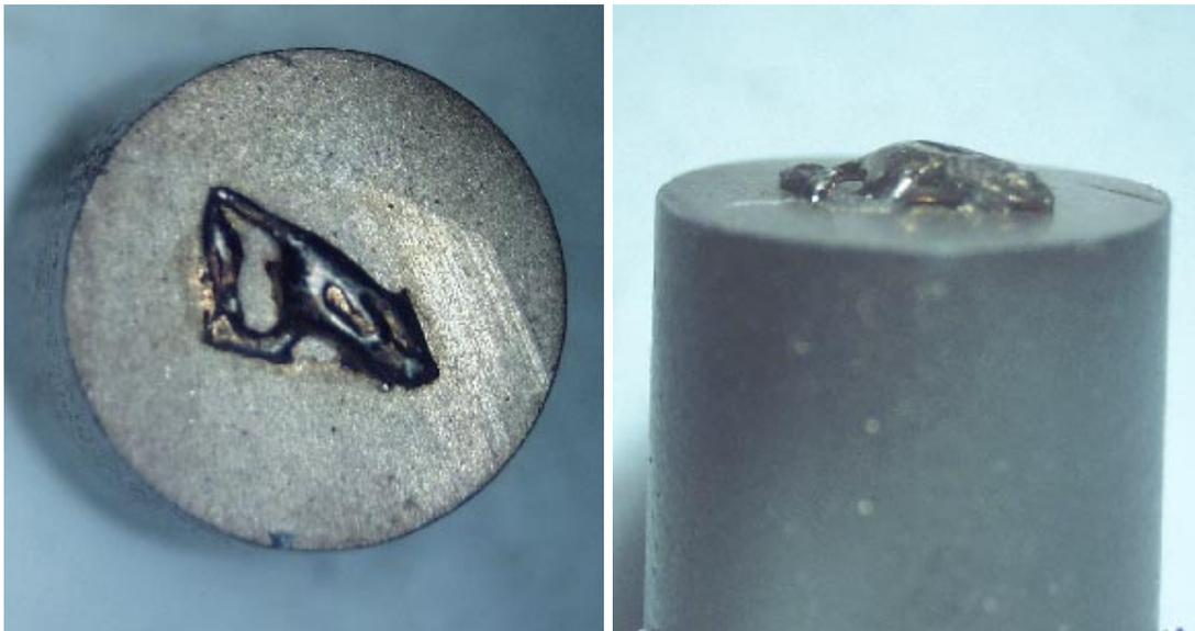
Figura 27: Condição de não-molhamento da liga VH-780 sobre  $Al_2O_3$ .
