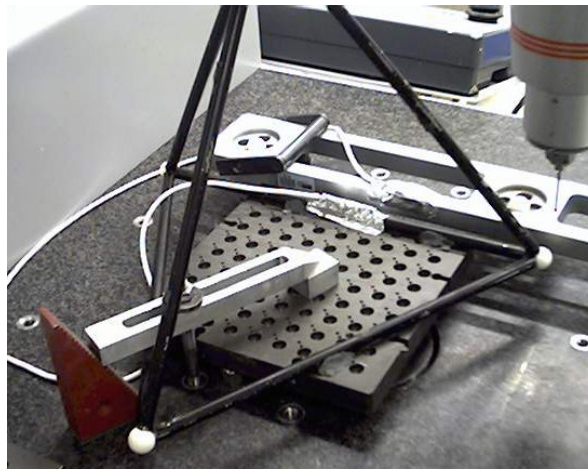
Figura 5.35: Calibração do tetraedro utilizando-se uma barra de esferas
