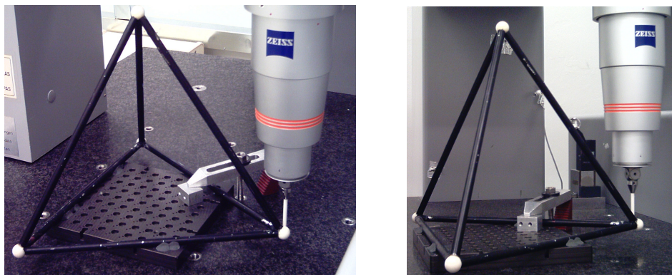
Figura 5.34: Uso de um tetraedro para inspeção rápida de uma MMC
