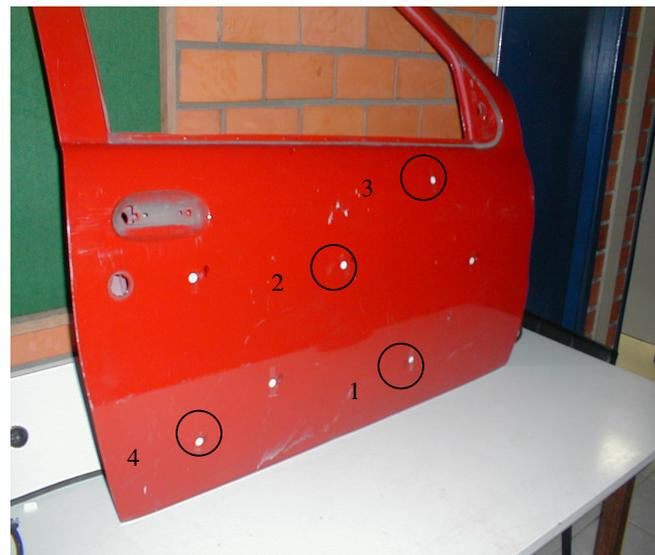
Figura 4.9 – Pontos de medição para o subsistema 1 da porta
