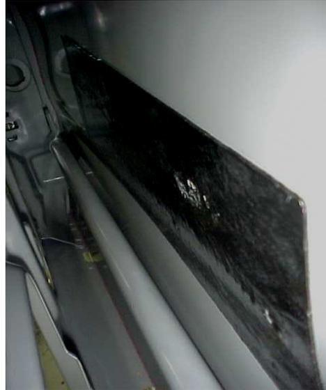
Figura 4.5 – Porta com amortecedor central (insonorizante entre painel e ossatura)
