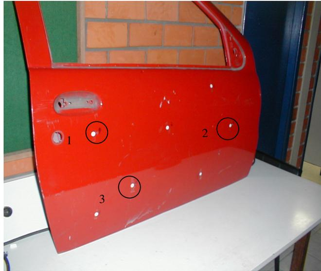
Figura 4.8 – Pontos de excitação para o método de potência de entrada
