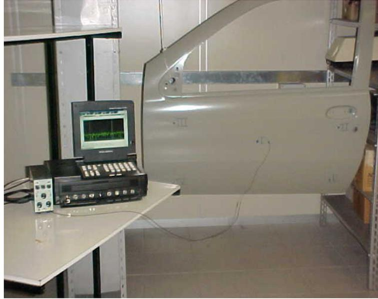
Figura 3.4 – Método de decaimento montagem do experimento
