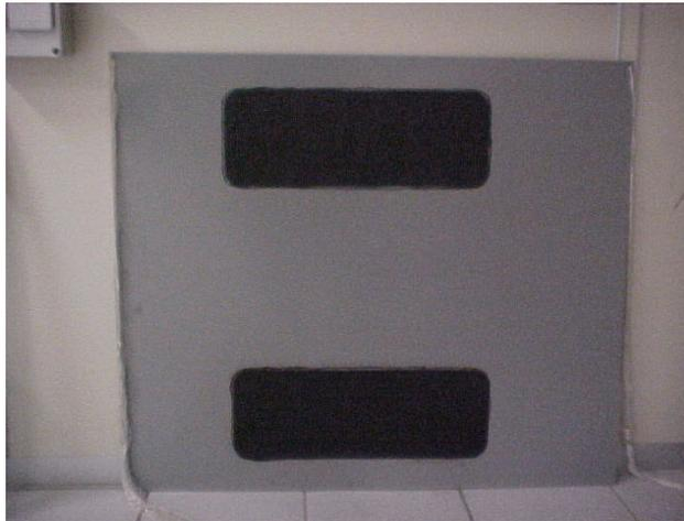
Figura 4.1– Amortecimento duplo na placa plana
