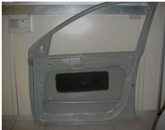
Figura 2.1 – Amortecedor acústico localizado na porta do veículo (exemplo)
