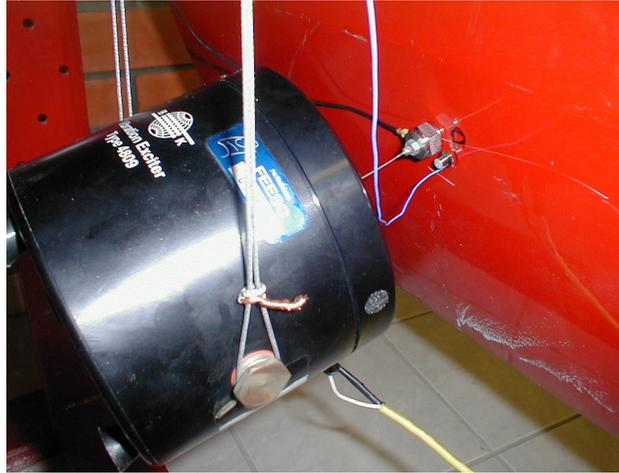
Figura 4.10 – Montagem do shaker e do transdutor de força na porta
