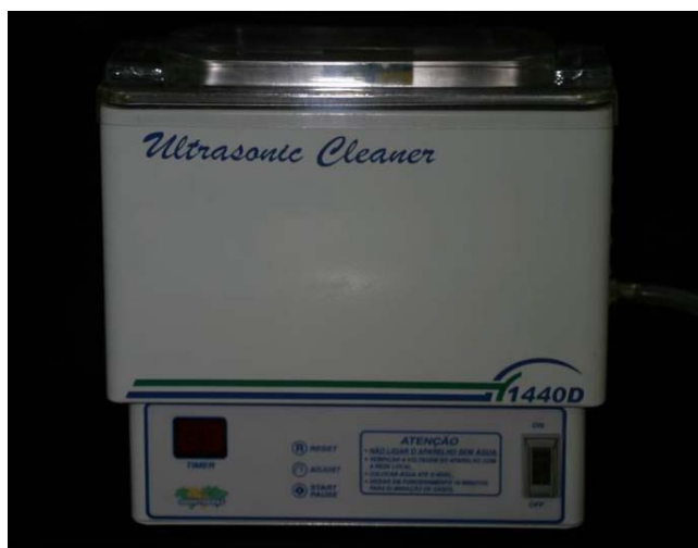
Figura 13 – Aparelho utilizado para o banho ultra-sônico dos espécimes.
