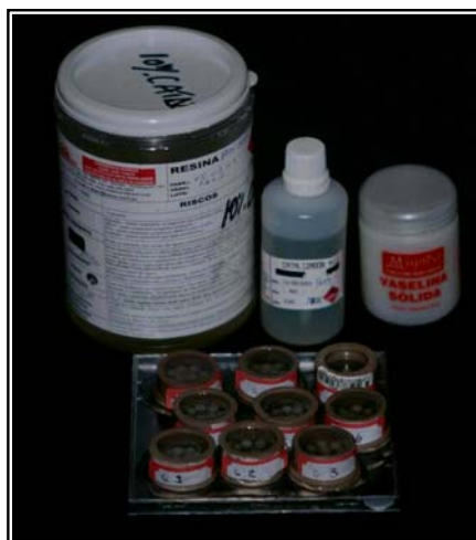
Figura 10 – Resina epóxi e tubos de PVC.
