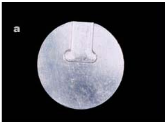
Figura 5A – Base do aparato metálico utilizado para obtenção dos corpos de prova para o teste de tração.
