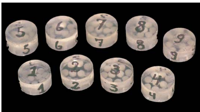
Figura 11A – Blocos em resina epóxi contendo espécimes de RC para o teste de microdureza.
