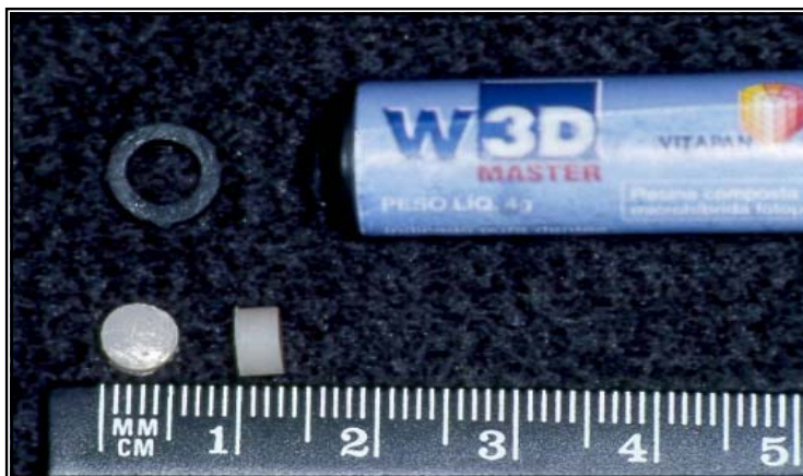
Figura 9 – Matriz utilizada para obtenção dos corpos de prova para o teste de microdureza e corpo de prova finalizado com suas medidas.
