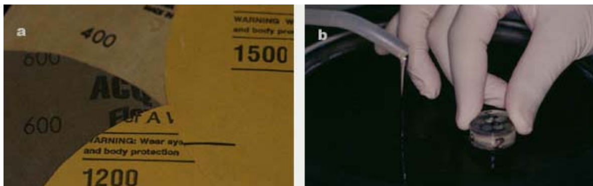
Figura 12A – Lixas para acabamento e polimento dos corpos de prova para o teste de microdureza superficial.
