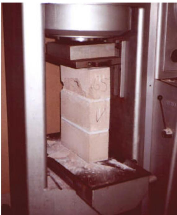
Figura 5.6 – Forma de ruptura para os prismas com argamassa industrializada
