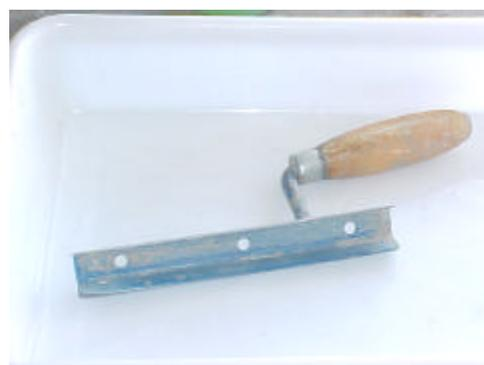
Figura 4.5 – Ferramenta utilizada na aplicação da argamassa.
