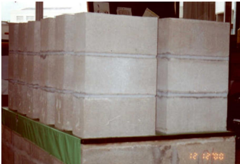
Figura 4.4 – Mesa de moldagem dos prismas.
