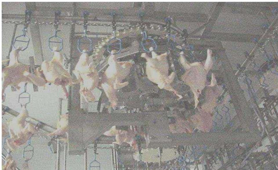
**Foto 1 – Nória que transporta o frango do Abate para o Processamento**
