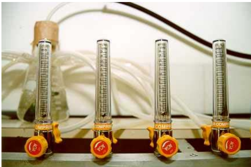
Figura 7 – Fluxômetros utilizados para controle da vazão de entrada de ar nas colunas
