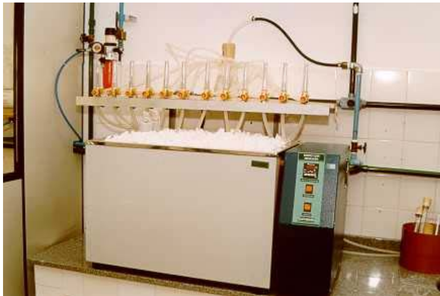
Figura 1 – Sistema fermentativo para cultivo em meio sólido utilizando reatores de coluna.
