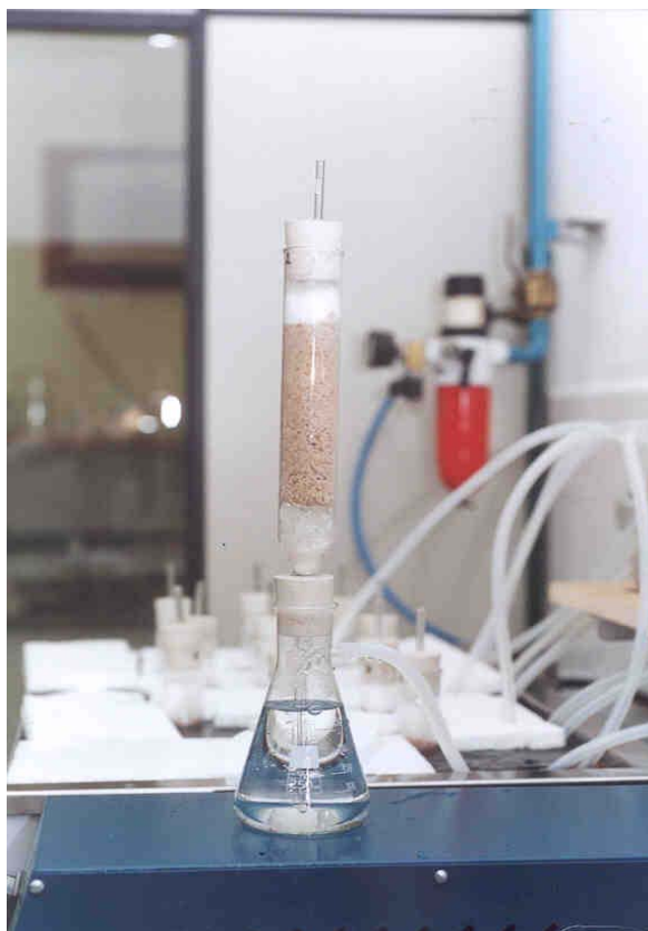
Figura 5 – Coluna de vidro, encaixada ao sistema de umidificação secundário
