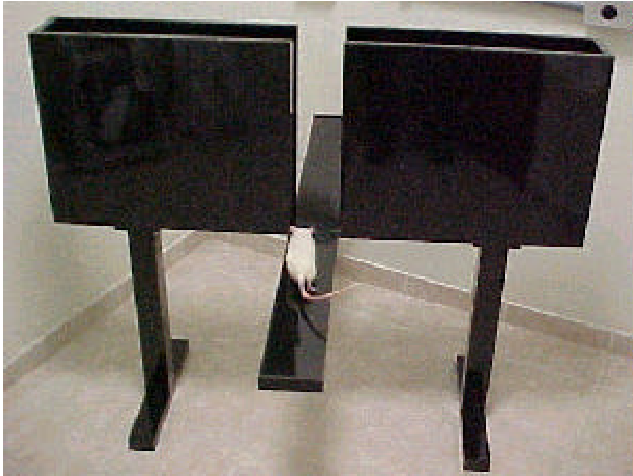
Figura 2- Labirinto em cruz elevado (LCE) para avaliação de comportamentos relacionados à ansiedade.
