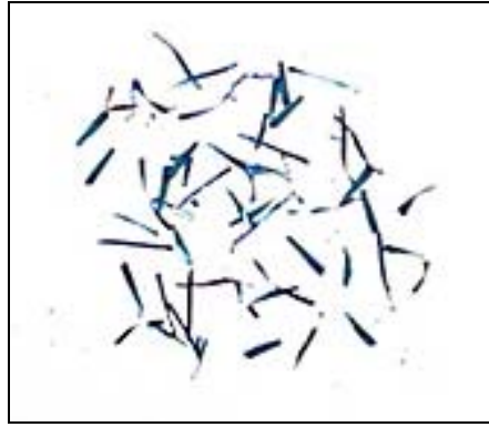
Figura 4.4 - Cavaco azulado com forma de fita helicoidal curta.
