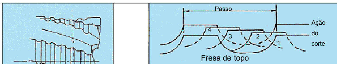
Figura 2.6 - Gume com quebra-cavaco plano [16].
