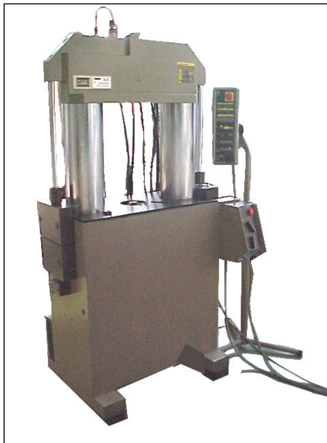
Figura 3.6 – Máquina MTS de teste dinâmico.
