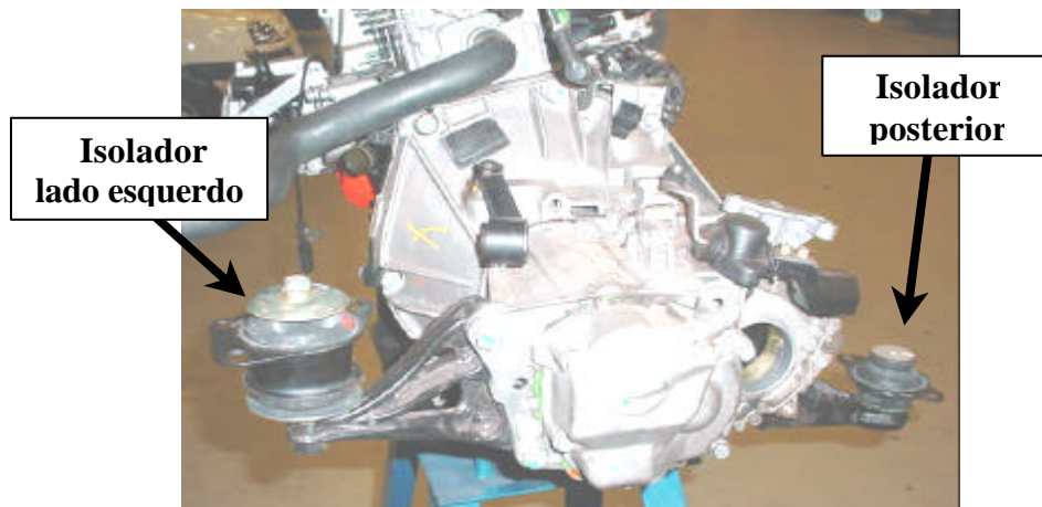
Figura 3.3 – Posicionamento dos isoladores do motor – vista lateral esquerda do motor.
