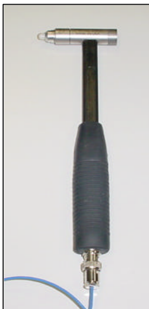
Figura 3.14 – Martelo de impacto para teste de resposta em frequência do volante.
