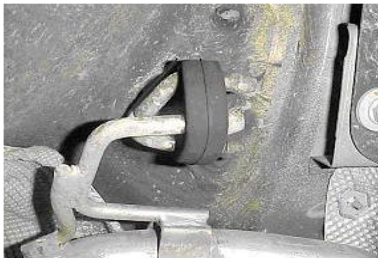
Figura 2.3 – Ponto de fixação do sistema de exaustão do veículo via coxim.
