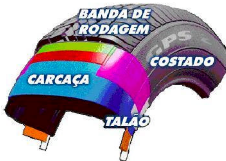
Figura 2.4 – Pneu e seus principais componentes.
