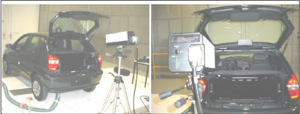
Figura 3.11 – Posicionamento da “cabeça scanner” para medições de vibração na superfície frontal do volante.
