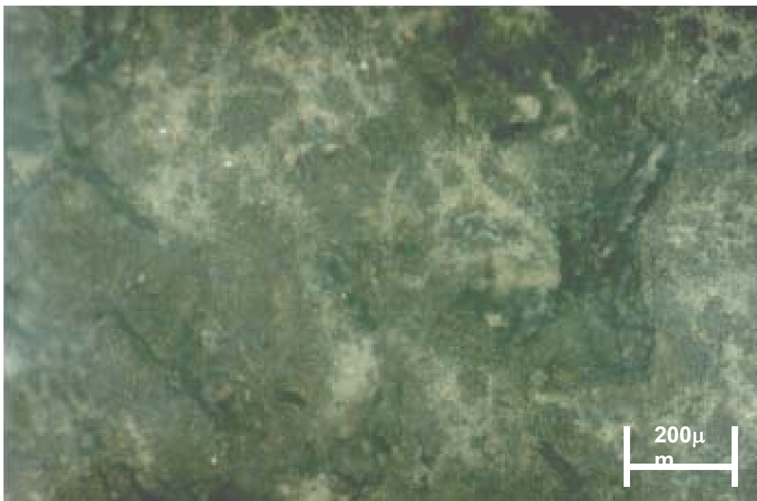
Figura 55 – Fotografia da superfície do corpo de ensaio com acabamento superficial em lixa #600 após ataque químico.
