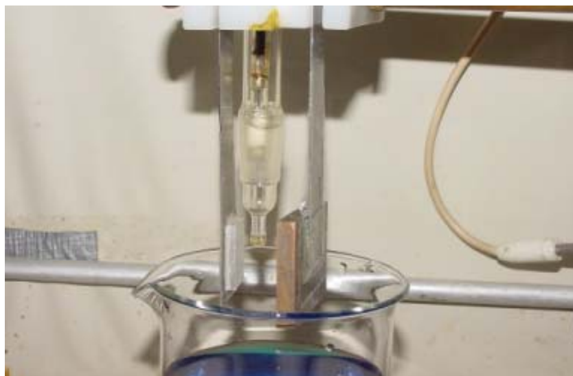
Figura 44 – Esquema da montagem da chapa de alumínio com o corpo de ensaio e o contra-eletrodo de cobre fosforoso.
