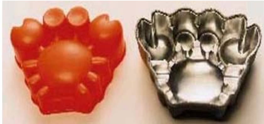
Figura 12 – Protótipo com revestimento metálico (à direita) após aplicação pelo processo da pulverização metálica por plasma [42].
