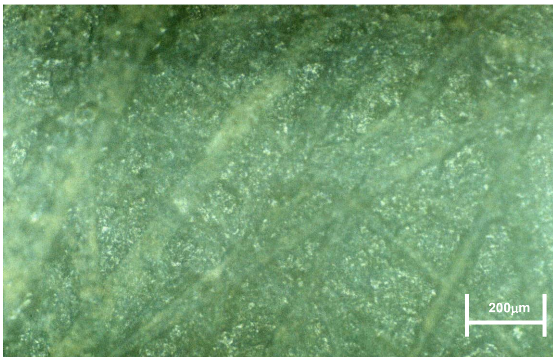
Figura 53 – Fotografia da superfície do corpo de ensaio com acabamento superficial em lixa #220 após ataque químico.
