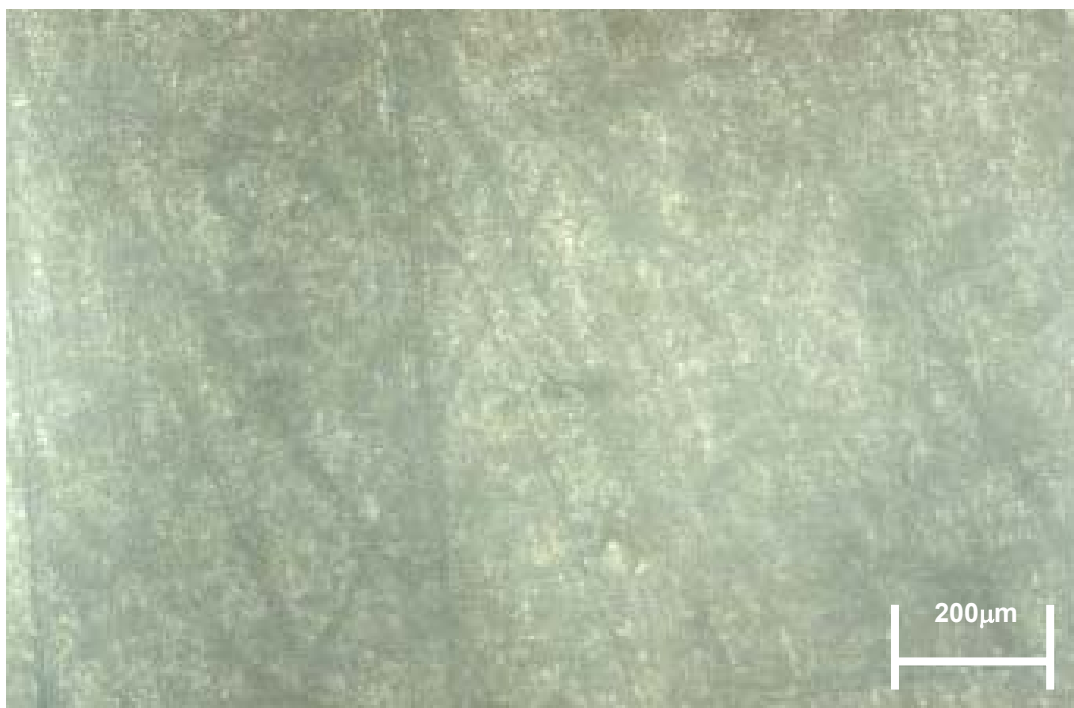
Figura 55 – Fotografia da superfície do corpo de ensaio com acabamento superficial em lixa #600 após ataque químico.
