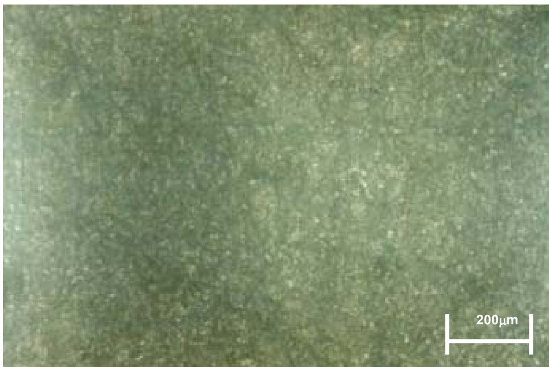
Figura 49 – Fotografia da superfície do corpo de ensaio com acabamento superficial em lixa #600.
