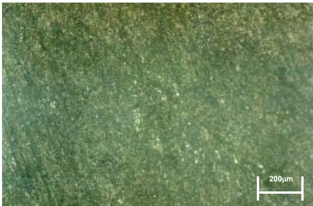
Figura 61 – Foto da superfície do corpo de ensaio com acabamento superficial em lixa #600 após etapa do níquel químico.
