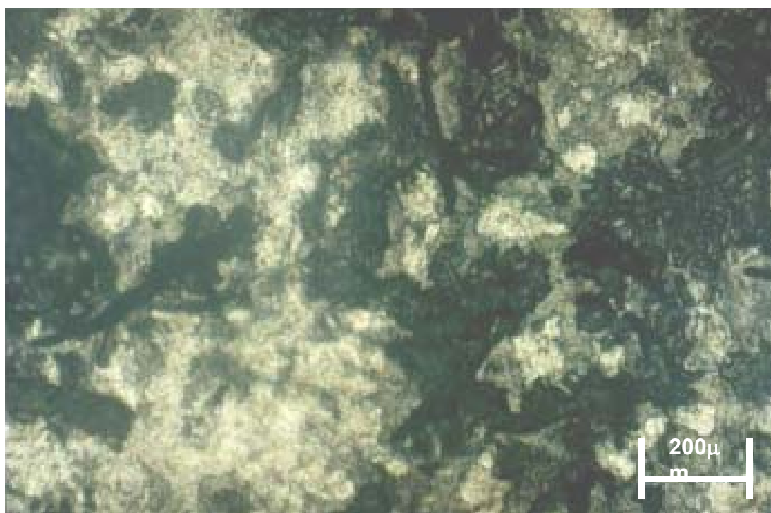
Figura 62 – Foto da superfície do corpo de ensaio com acabamento superficial por jateamento após etapa do níquel químico.
