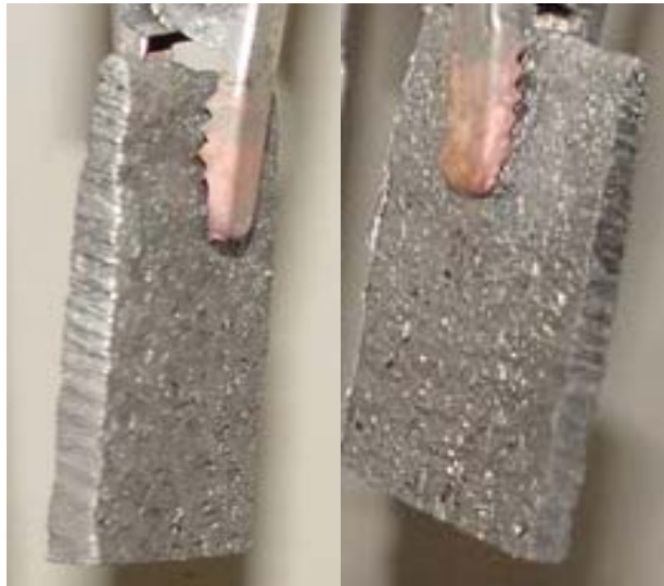
Figura 32 – Contra-eletródo em níquel usinado no Laboratório LMP e utilizado na solução Níquel Brilhante®.
