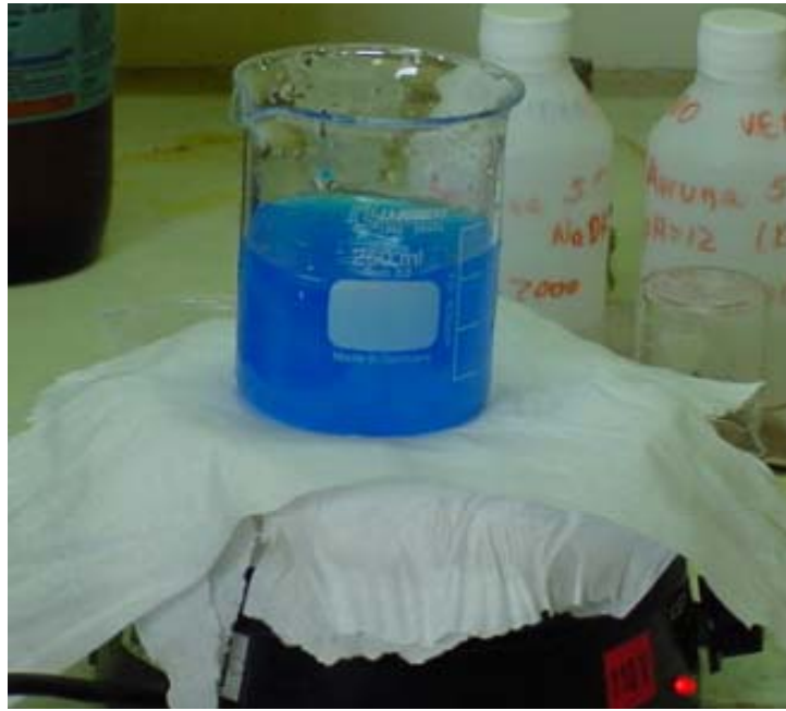
Figura 30 – Solução contendo sulfato de cobre sendo dissolvido em água deionizada e bidestilada agitada magneticamente e aquecida até 45°C.
