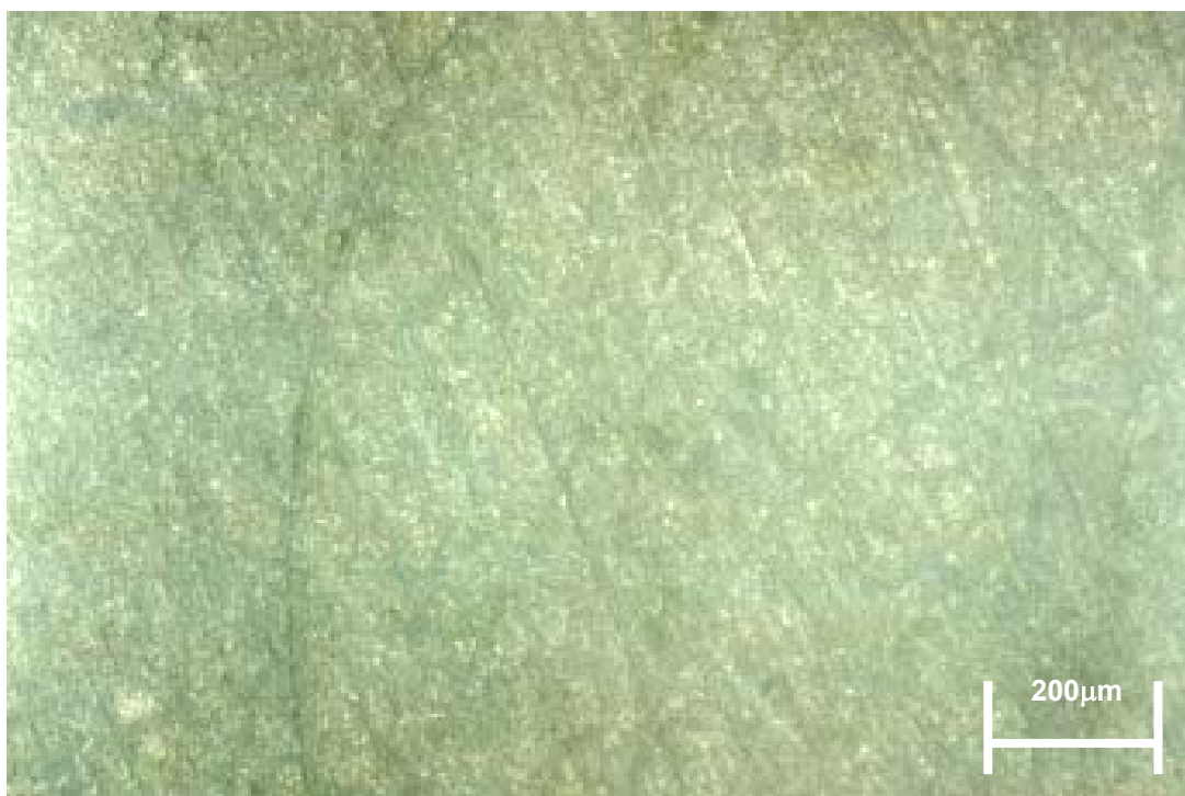
Figura 54 – Fotografia da superfície do corpo de ensaio com acabamento superficial em lixa #400 após ataque químico.
