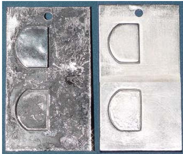
Figura 75 – Amostra eletrodepositada na empresa Boreal (esquerda) e amostra eletrodepositada no Laboratório de Filmes Finos e Superfícies da UFSC (direita).
