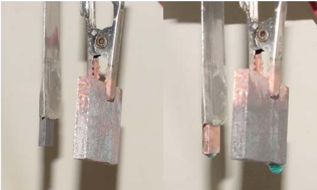
Figura 65 – Corpo de ensaio e contra-eletrodo antes da eletrodeposição de cobre (esquerda) e depois da eletrodeposição (direita).
