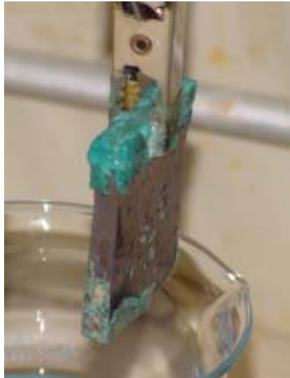
Figura 83 – Precipitação do sulfato de cobre sobre as extremidades do contra-eletródo.
