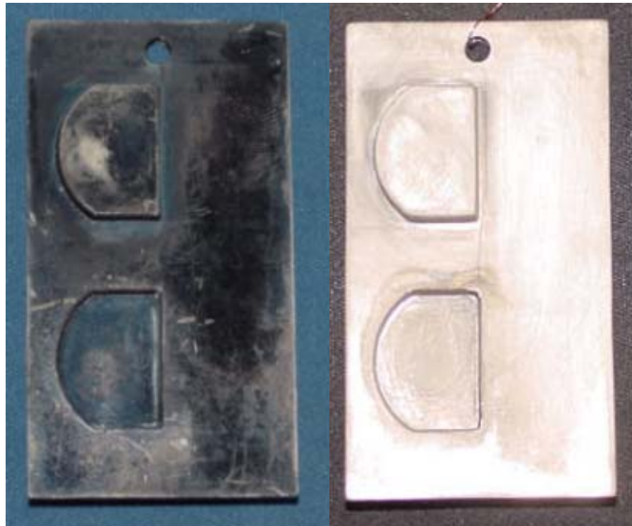
Figura 70 – Amostra depositada com níquel químico na empresa Boreal (esquerda) e amostra depositada com níquel químico no laboratório da UFSC (direita).
