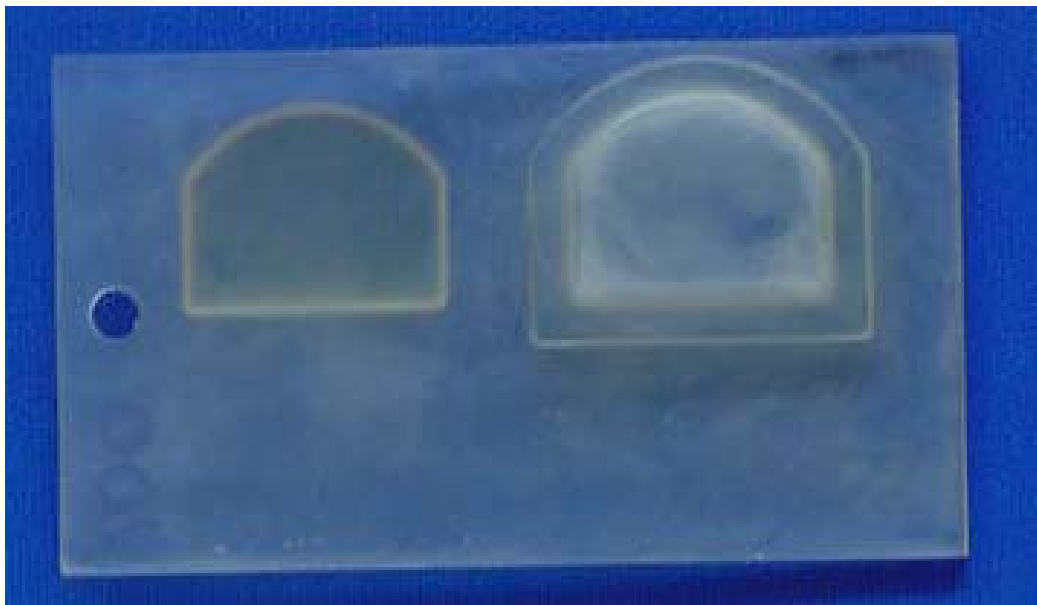
Figura 35 – Amostra confeccionada pelo processo de estereolitografia e utilizada no segundo experimento complementar.
