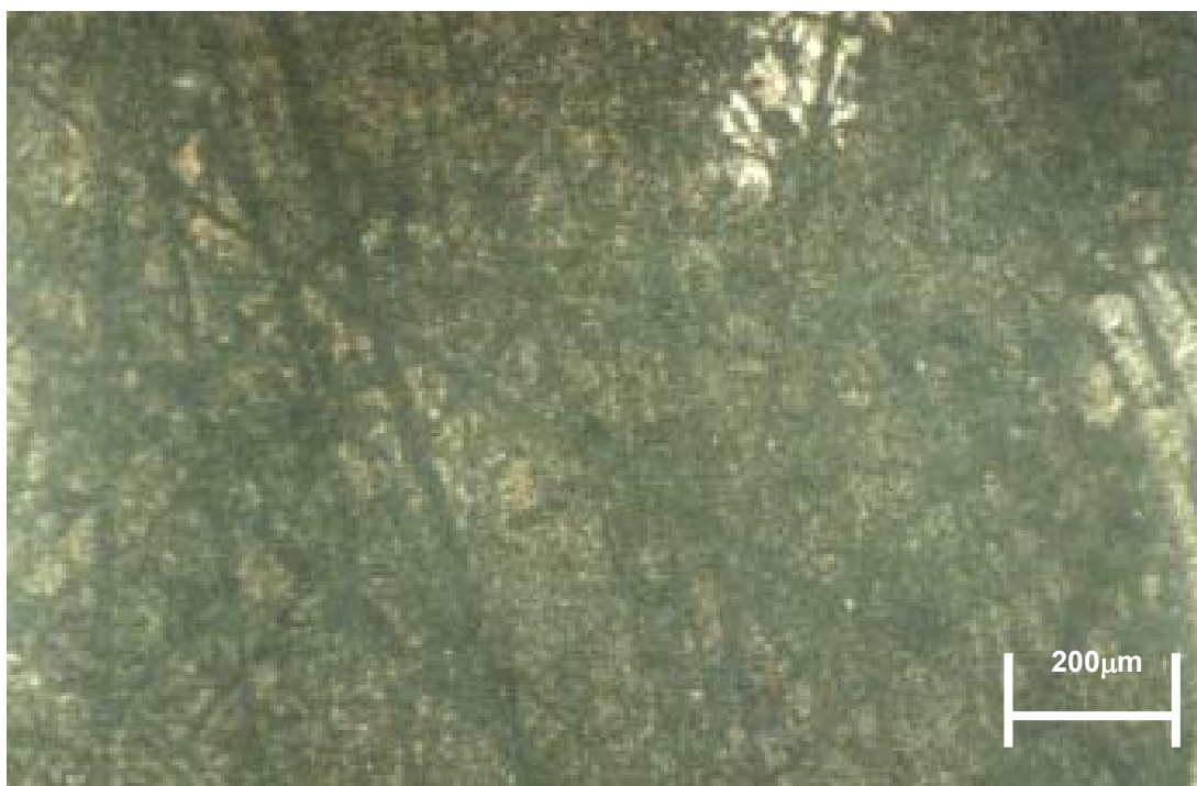
Figura 60 – Fotografia da superfície do corpo de ensaio com acabamento superficial em lixa #400 após etapa do níquel químico.
