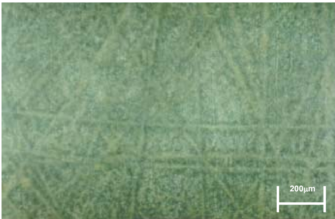
Figura 52 – Fotografia da superfície do corpo de ensaio com acabamento superficial em lixa #100 após ataque químico.
