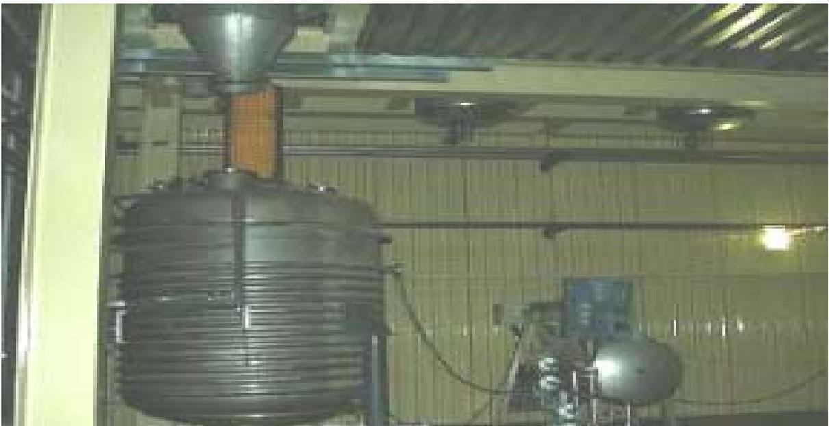
Figura 21 – Reator para Processos de Dissolução e Purificação de Extratos
