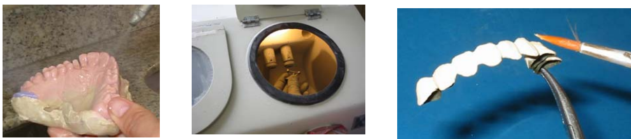
Figura 4.19 - Exemplos de preparação para confecção do produto, desinfecção com vapor, jateamento com óxido de alumínio e aplicação de porcelana opaca para cobrir o metal.
