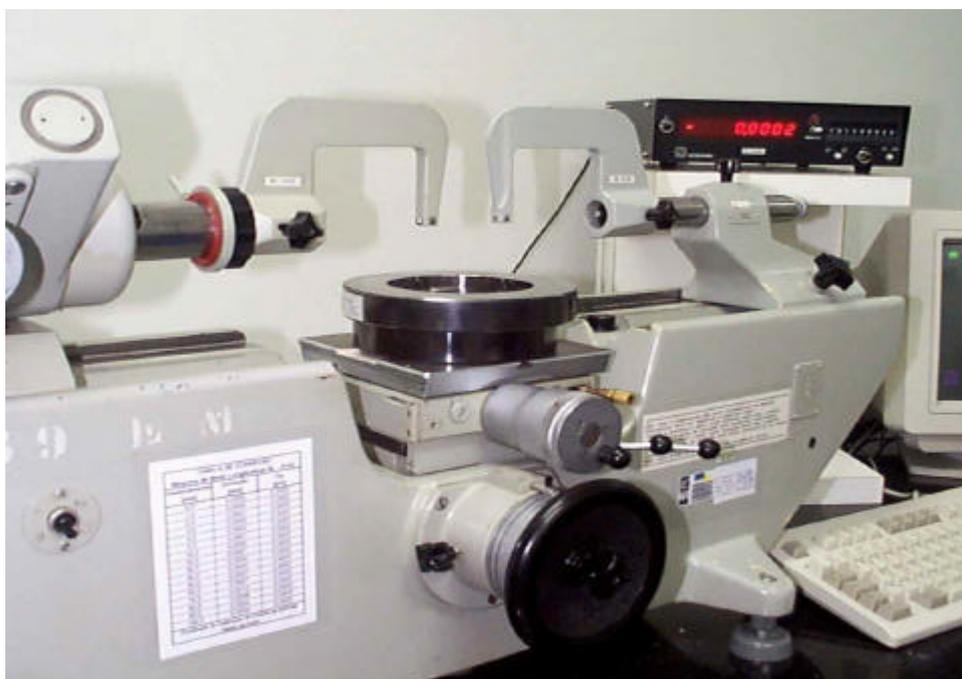
Figura 5.23 - Calibração do Calibrador Anel Liso Cilíndrico de 100 mm na Máquina de Abbé
