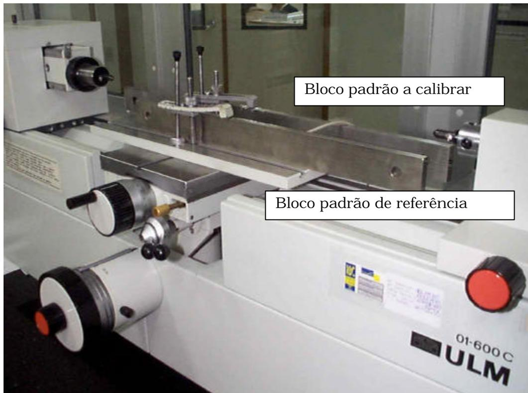
*Figura 5.11 - Calibração do bloco padrão na Máquina de Abbé*
