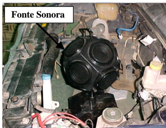
Figura 4.4 – Posicionamento da fonte sonora no vão do motor.
