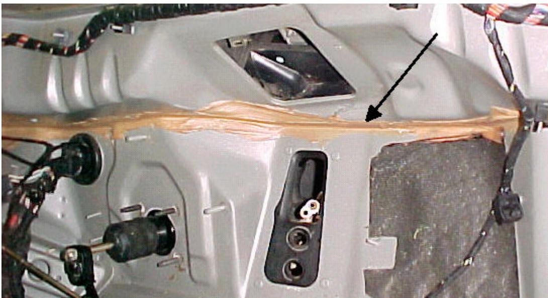
*Figura 5.1 – Aplicação de “Sigilatura” na parede frontal do veículo.*
