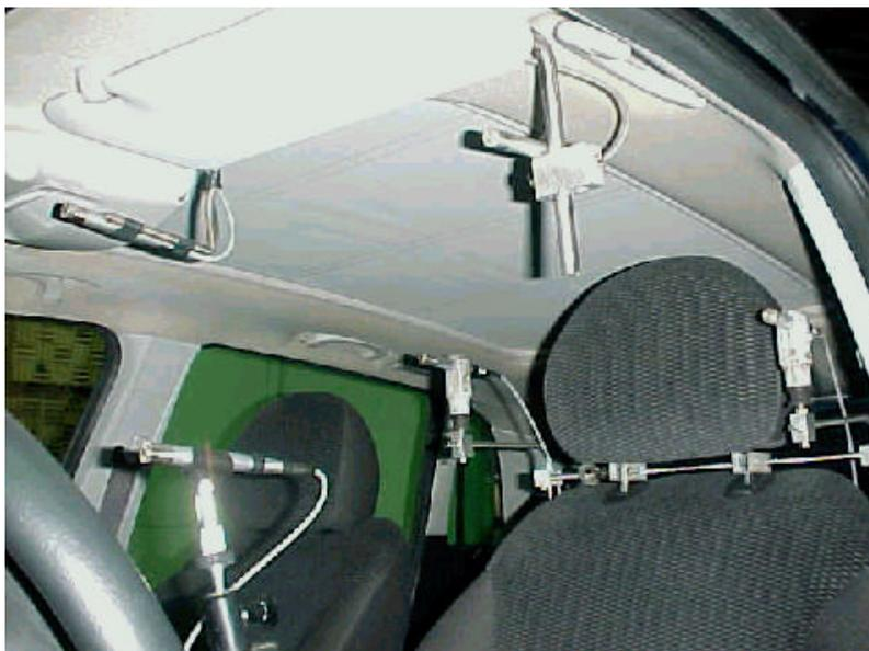
*Figura 5.5 – Vista frontal do posicionamento dos microfones na cavidade anterior esquerda do veículo.*
