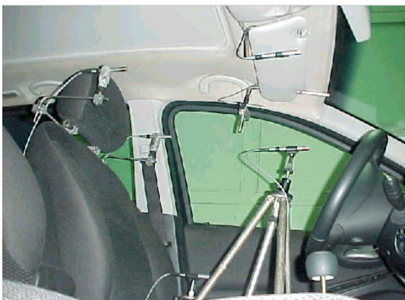
*Figura 5.6 – Vista lateral do posicionamento dos microfones na cavidade anterior esquerda do veículo.*
