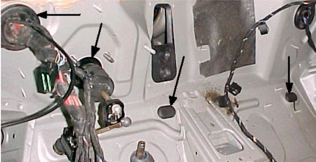
*Figura 5.2 – Utilização de tampões na parede frontal do veículo.*
