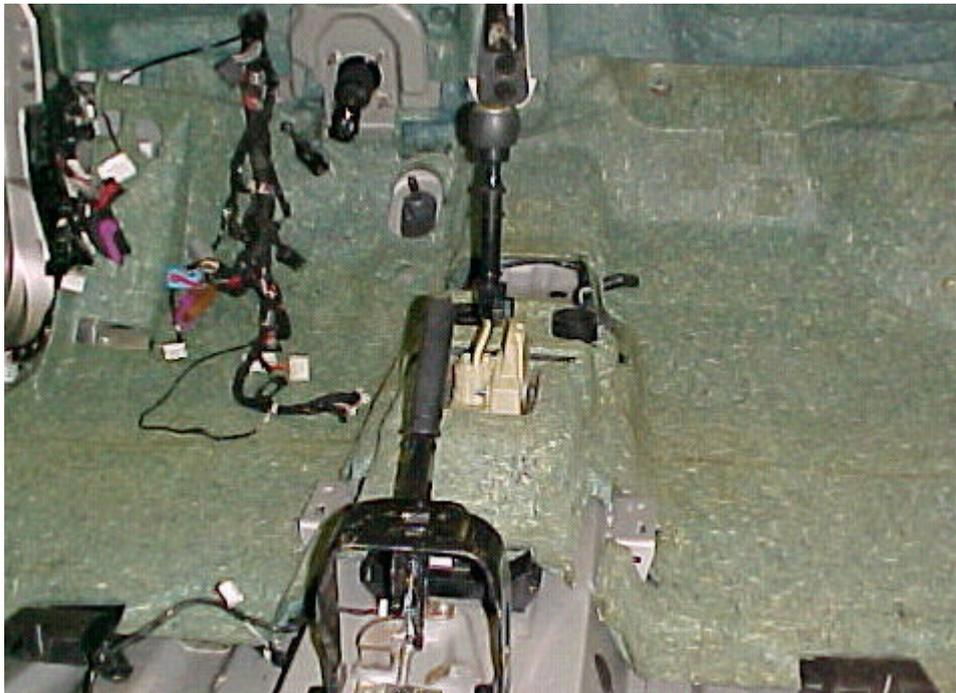
*Figura 5.4 – Utilização de isolamentos na parede frontal e assoalho do veículo.*
