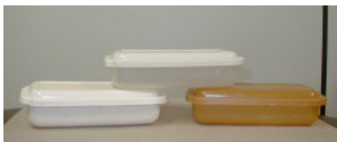
Figura 3.6: Amostras dos potes de PHB natural, pigmentado e de PP
