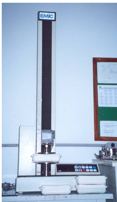
Figura 4.3: Compressão do pote PHB pigmentado
