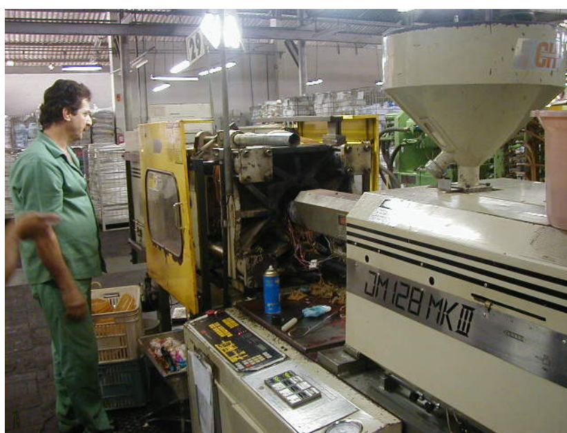
Figura 3.2: Vista da injetora que produziu o pote
