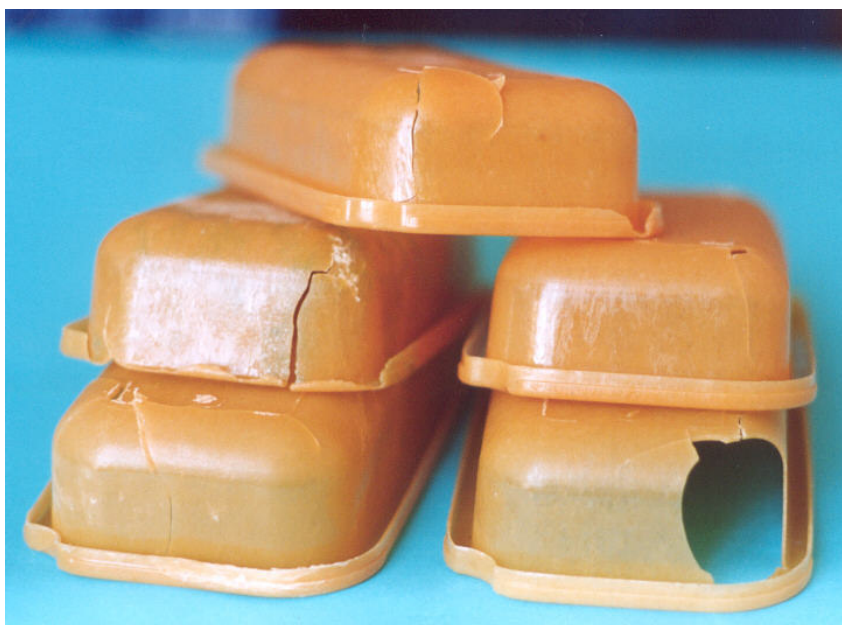
Figura 4.5: Potes de PHB natural após impacto
