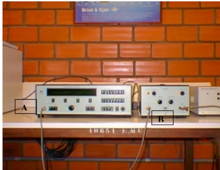
Figura 4.5: Gerador de Sinal/Ruído (A) e Amplificador de Potência Tipo 2706 (B).
