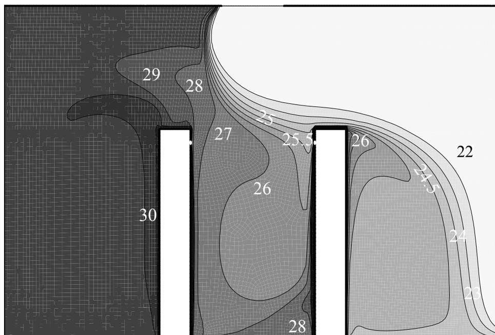
Figura 6-12 Configuração inicial ( $t = 0$ ) das isotermas.
