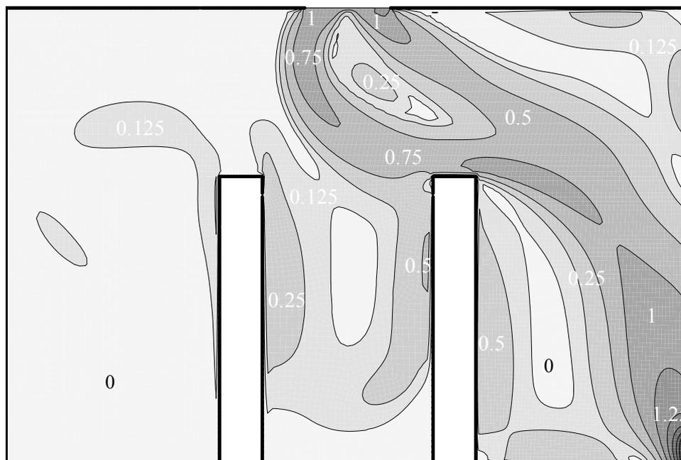
Figura 6-26 Magnitude da velocidade 10,22 segundos após o instante inicial.
