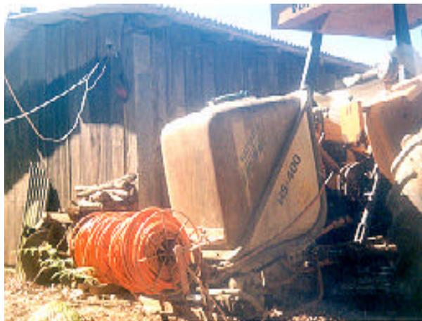
Figura 16. Conjunto de instrumentos usados na pulverização (tanque, bomba de pressão, mangueira, trator).
