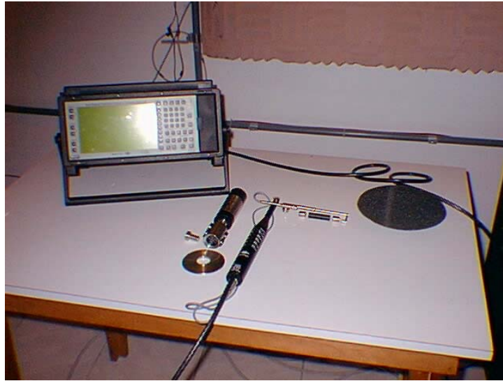
Figura 4.11: Sistema de medição de intensidade sonora
