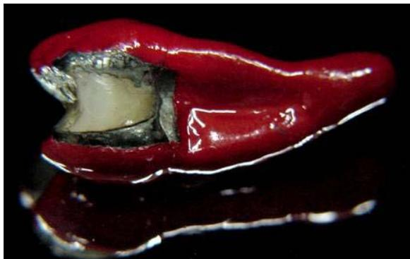
Figura 20 – Aspecto do espécime após a imersão em solução de nitrato de prata 50% por 4h.
