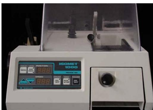
Figura 21 – Máquina para seccionamento dos espécimes.
