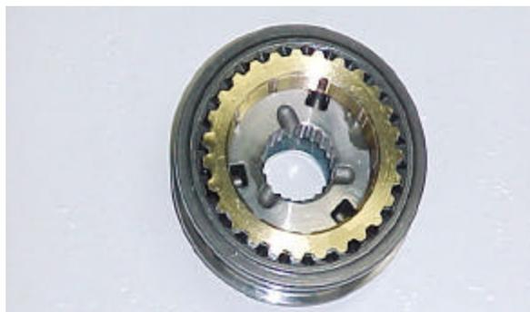
Figura 3.19 – Foto do conjunto sincronizador 5ª velocidade
