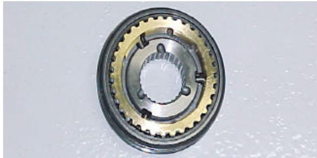
Figura 3.18 – Foto do conjunto sincronizador 3ª /4ª velocidade
