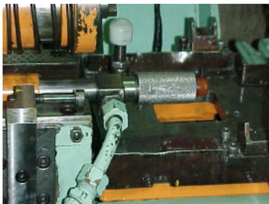
Figura 4.6 – Foto do dispositivo de aplicação de óleo no câmbio
