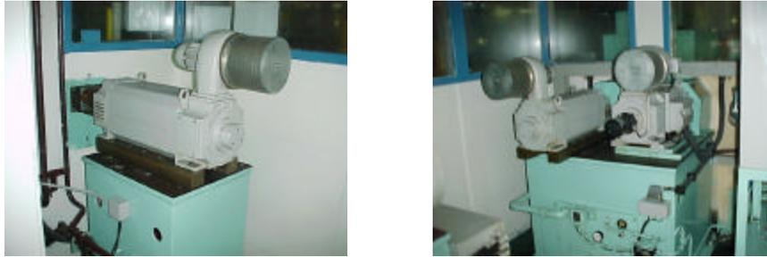
Figura 4.1 – Foto dos motores principal e secundários dos bancos de prova
