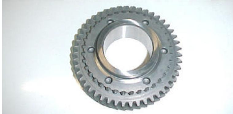
Figura 3.10 – Foto da Engrenagem Conduzida 2ª velocidade
