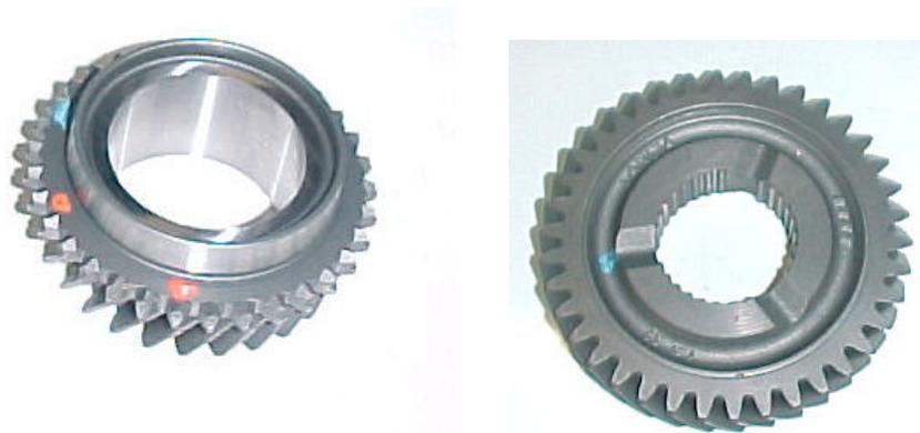
Figura 3.11 – Foto Engrenagens: Condutora 3ª velocidade / Conduzida 3ª velocidade
