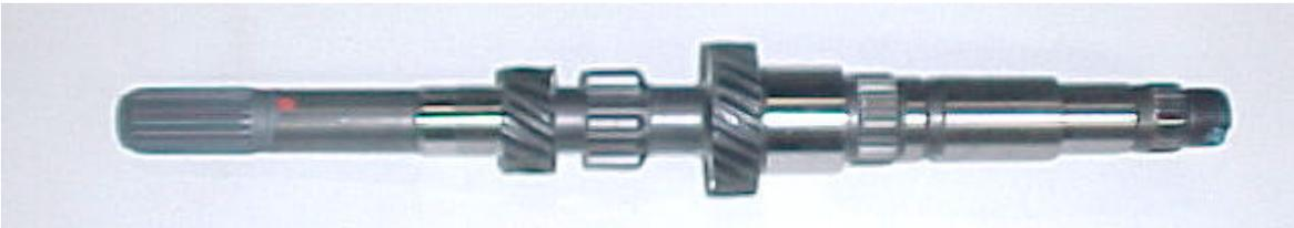
Figura 3.5 – Foto do Eixo Primário
