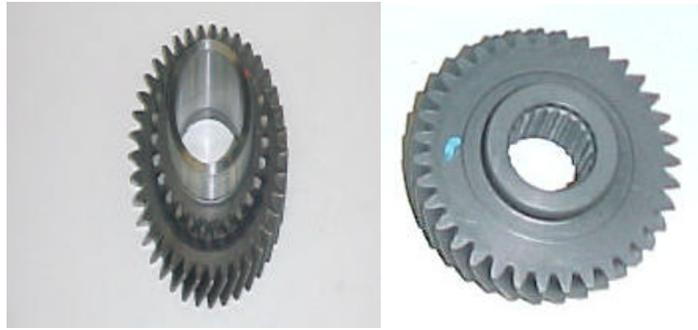
Figura 3.13 – Foto das Engrenagens: Condutora 5ª velocidade / Conduzida 5ª velocidade
