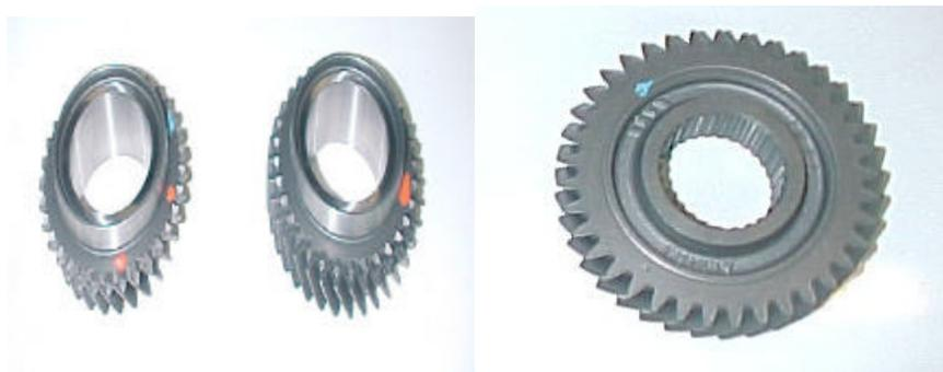
Figura 3.12 – Foto das Engrenagens: Condutora 4ª velocidade / Conduzida 4ª velocidade
