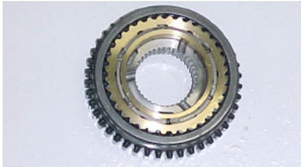
Figura 3.17 – Foto do conjunto sincronizador 1ª /2ª velocidade
