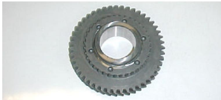
Figura 3.9 – Foto da Engrenagem Conduzida 1<sup>a</sup> velocidade
