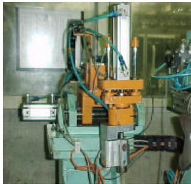
Figura 4.5 – Foto do braço mecânico de posicionamento do acelerômetro
