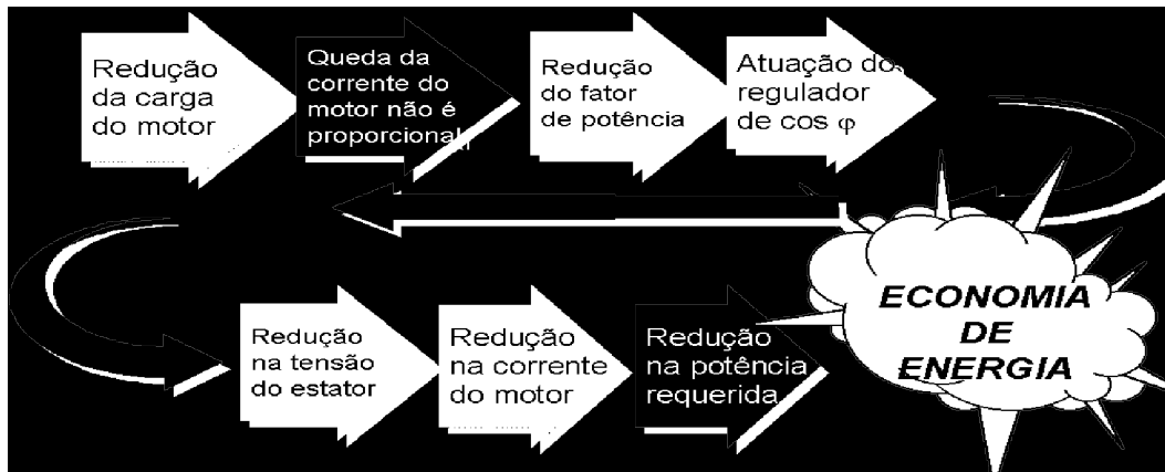
Figura 2. 35: Diagrama da seqüência das operações do Drive (SIEMENS, 2001).
