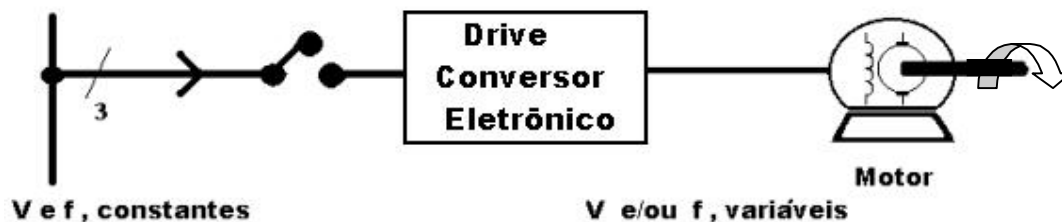
Figura 2. 20: Motor na condição off-line , controlado por Drive , conversor eletrônico, tensão (V) e/ou frequência (f) variáveis.
