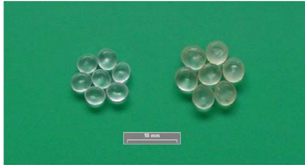
Figura 31 - EVA normal (esquerda) e intumescido após imersão no hexano (direita)
