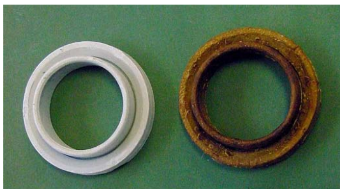
Figura 46 – Peça normal (esquerda) e peça com defeito formado no início de remoção térmica (direita)
