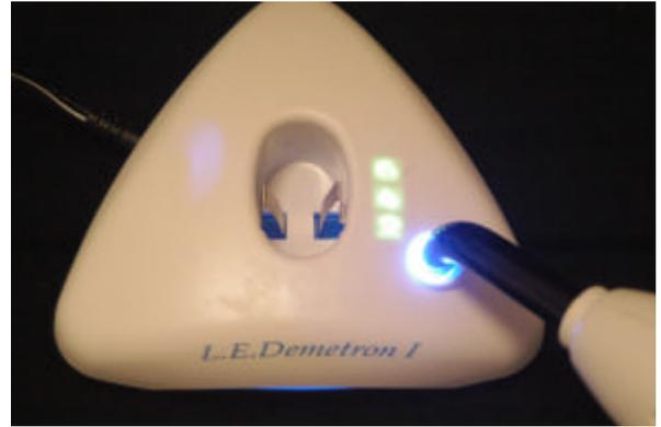
Figura 5 – Mensuração da intensidade da luz emitida pelo fotoativador, em  $\text{mW}/\text{cm}^2$ , com o radiômetro de cura do aparelho L.E.Demetron
