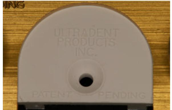
Figura 7 – Matriz de teflon com orifício por onde a resina composta será inserida
