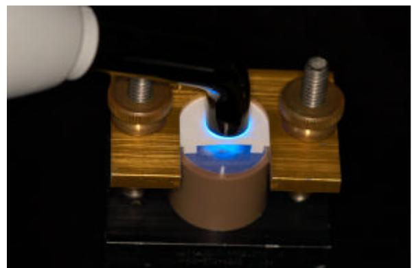
Figura 9 – Fotoativação do incremento de resina composta
