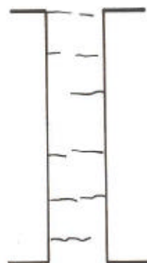
Figura 2 - Fissuras em pilar causadas por tração no sentido longitudinal – Fonte: Verçosa, 1991.
