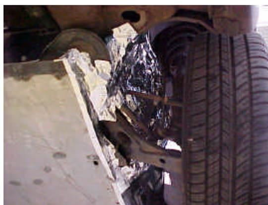
**Figura 4.9** Isolamento das laterais
