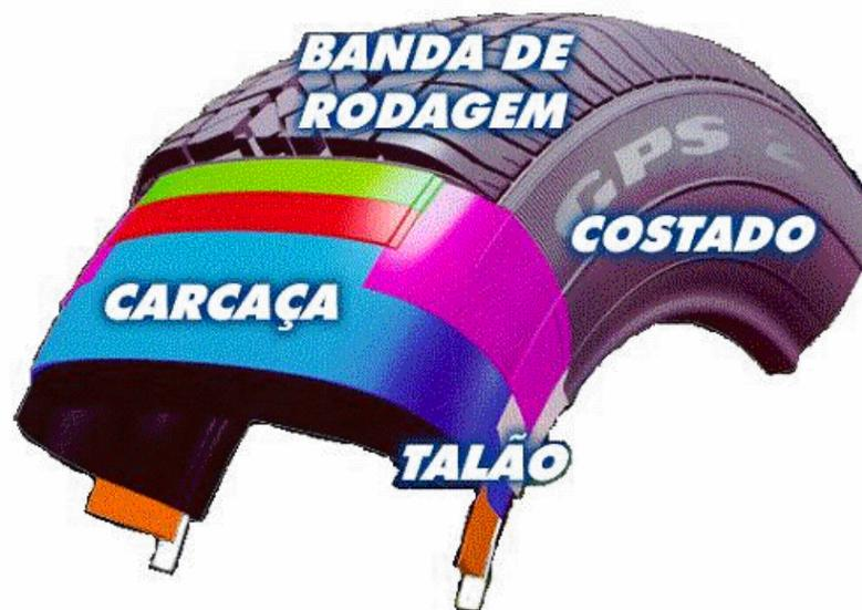
**Figura 2.11** Aspectos construtivos do pneu
