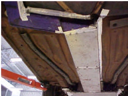
**Figura 4.10** Isolamento da parte central
