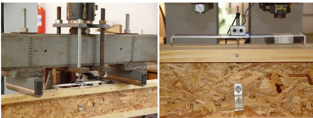
Figura 46 – Dispositivo utilizado para obter o módulo de elasticidade circular.
