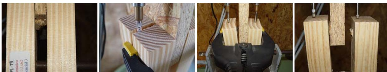
Figura 24 – Rupturas encontradas no ensaio de ligação.
