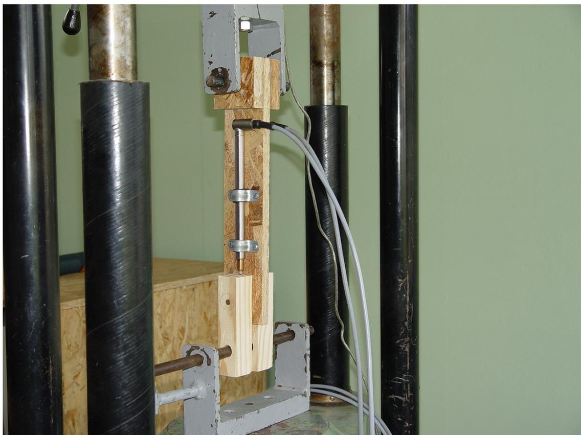
Figura 30 – Ensaio da ligação pregada entre a alma e as mesas da viga (2ª bateria).
