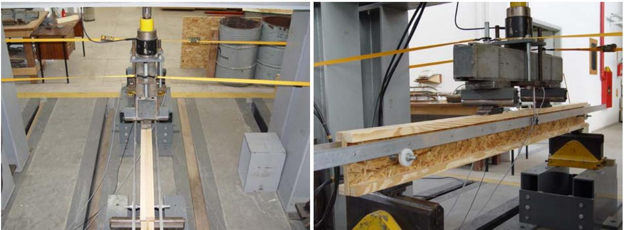
Figura 49 – Fixação do dispositivo de aplicação de carga por meio de um cinto.
