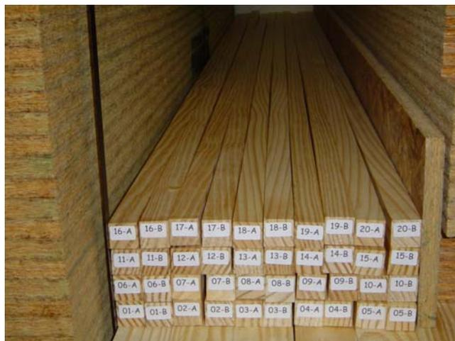
Figura 4 – Identificação das peças de Pinus com seção de 30x30 mm.
