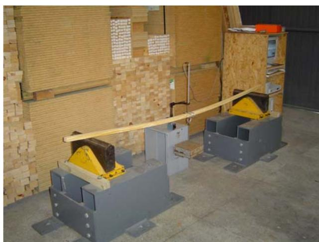
Figura 5 – Ensaio expedito de flexão a três pontos.
