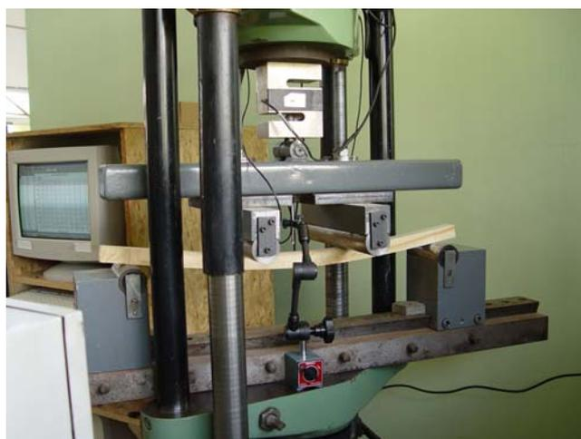
Figura 11 – Ensaio de flexão a quatro pontos.
