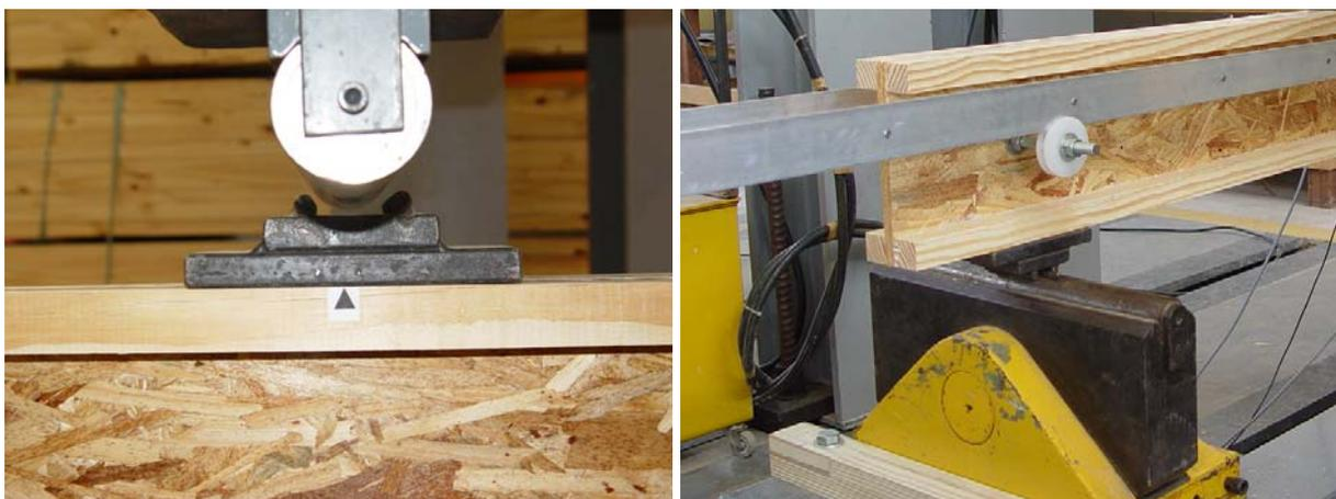
Figura 45 – Sapatas para distribuição dos esforços utilizadas nas vigas coladas.
