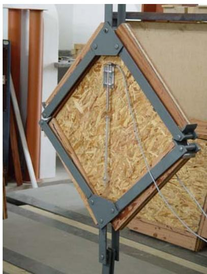
Figura 16 – Ensaio de cisalhamento.
