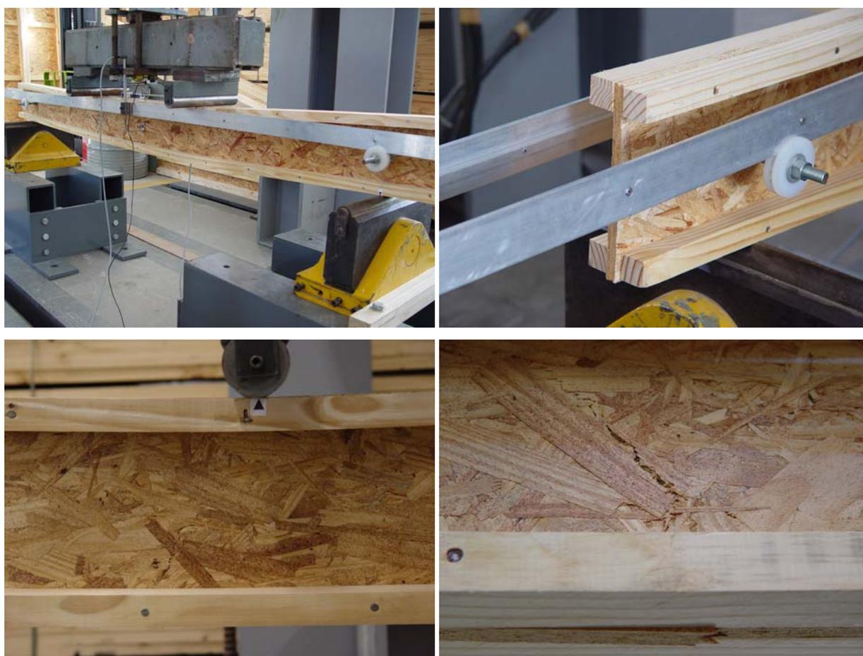
Figura 51 – Ruptura típica das vigas pregadas.
