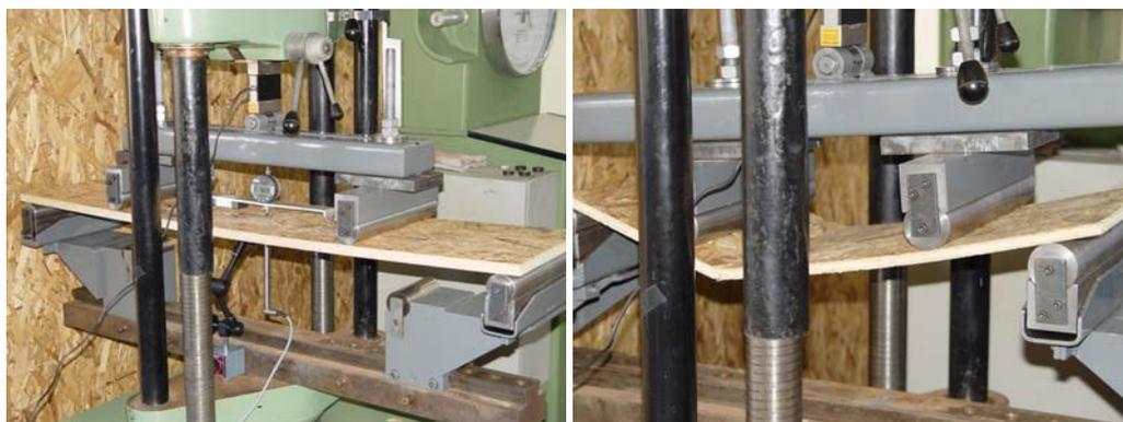
Figura 13 – Ensaio de flexão transversal e longitudinal.
