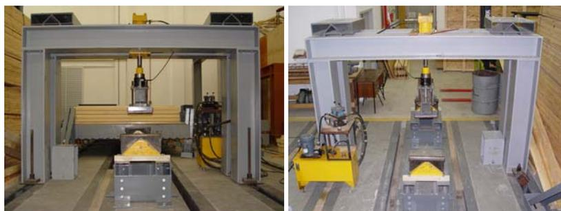
Figura 43 – Pórtico sobre a laje de reação no qual foram ensaiadas as vigas.
