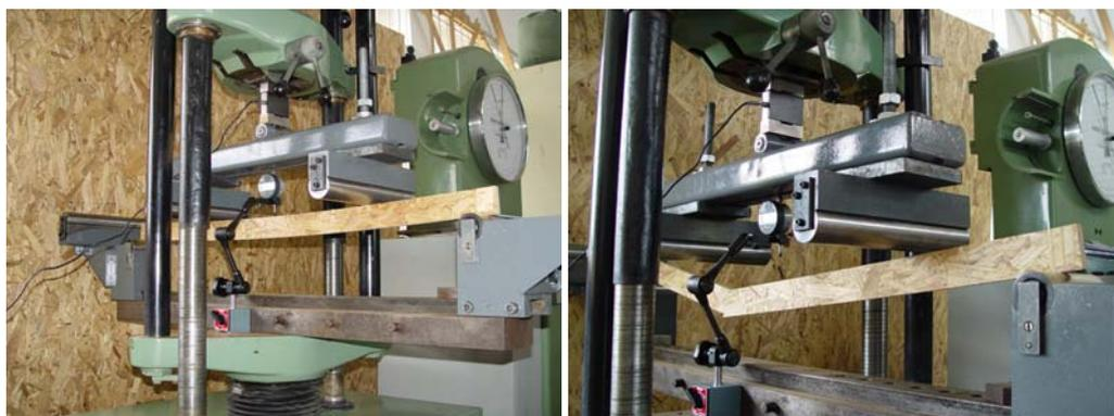
Figura 14 – Ensaio de flexão vertical.
