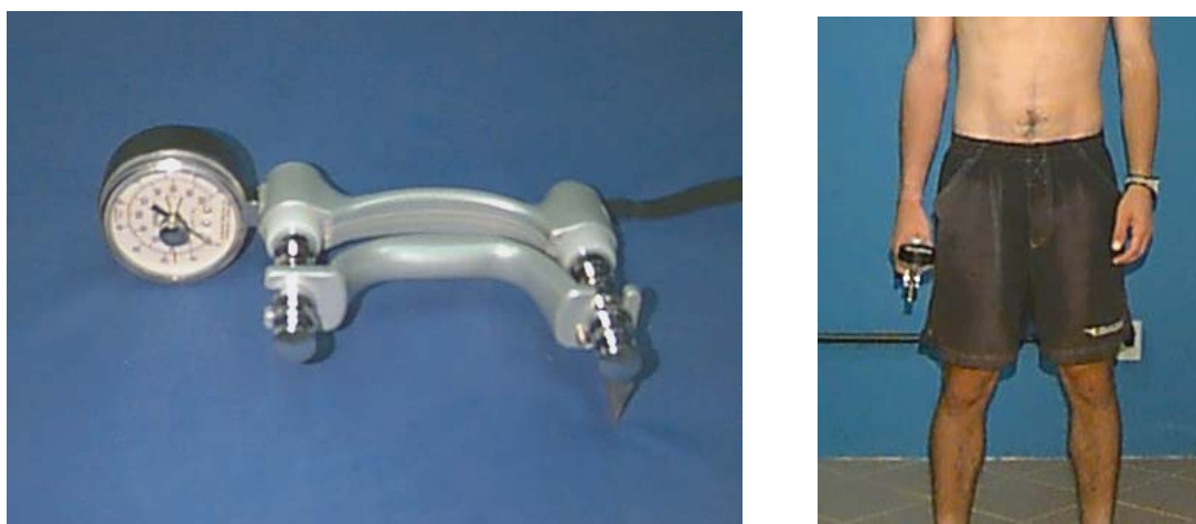
Figura 2 – Dinamômetro de preensão manual utilizado para o teste de força e a demonstração do procedimento utilizado para a coleta de dados
