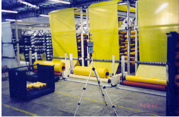
FIGURA 19 - PMV Data Logger instalado
