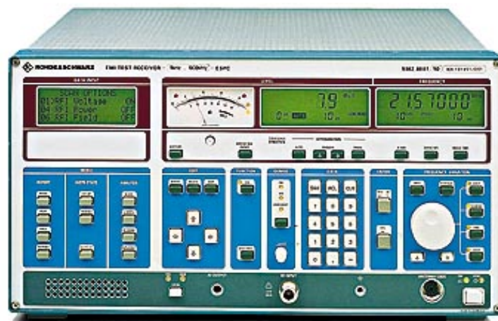
Fig. 2.1 – Foto do Receptor de Campos Eletromagnéticos utilizado para as medidas neste trabalho.
