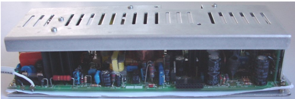
Fig. 5.47(c) – Fonte \delta com planos de terra abaixo e acima da PCI. O plano superior está conectado nos dissipadores.
