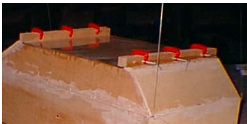
Figura 5.2: Posicionamento dos “sargentos” na estrutura.
