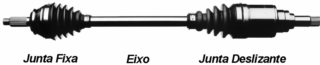
Figura 2.9: Configuração de um semi eixo homocinético.
