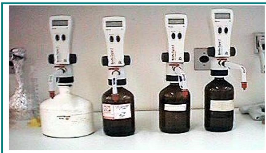
Figura 11: Buretas automáticas utilizadas nas titulações.
