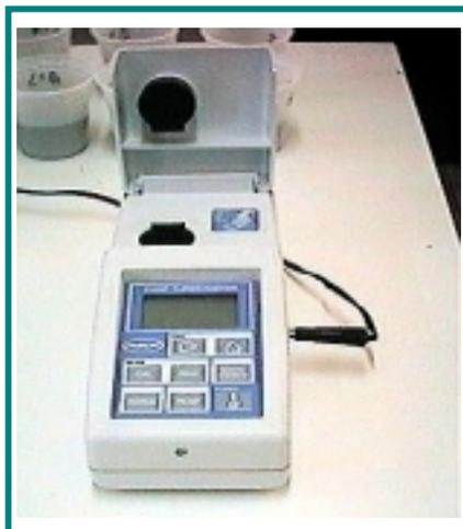
Figura 9: Turbidímetro Hach, utilizado nas determinações de turbidez.
