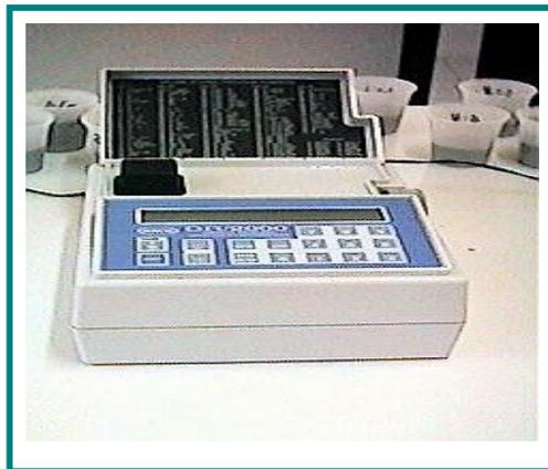
Figura 8: Espectrofotometro óptico Hach utilizado nas análises.
