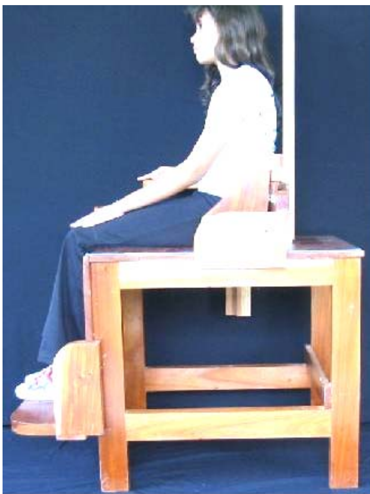
Figura 28: Antropômetro utilizado no estudo construído a partir do modelo concebido por Serrano e Paschoarelli.
