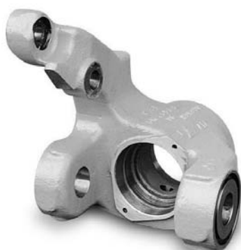
Figura 4.1 – Peça selecionada para o estudo de caso: alojador da ponta de eixo de motoniveladoras
