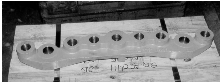
Figura 4.12 – Peça selecionada para o estudo de caso: barra de ligação de motoniveladoras
