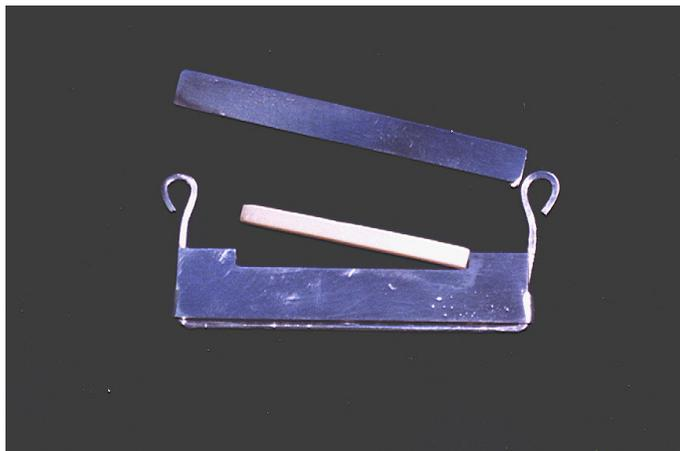
Figura 2F - Remoção do corpo-de-prova da matriz metálica.
