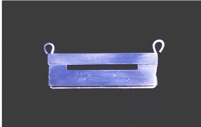
Figura 2A – Matriz metálica bipartida utilizada para a confecção dos corpos-de-prova.
