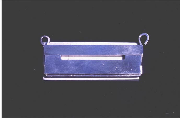
Figura 2B – Matriz metálica posicionada sobre uma lâmina metálica com uma película poliéster interposta.
