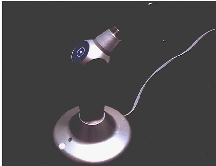
Figura 1C - Unidade fotoativadora por LED (Ultrablue – DMC).
