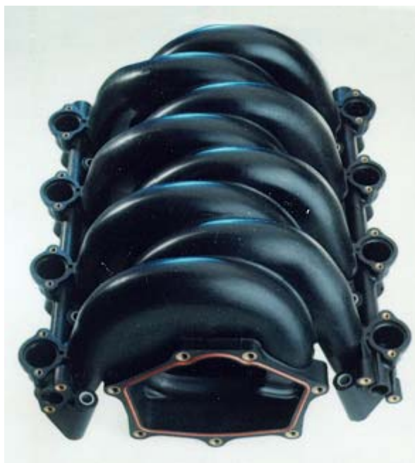
Figura 15 - Coletor de admissão fabricado pela técnica do núcleo perdido 43
