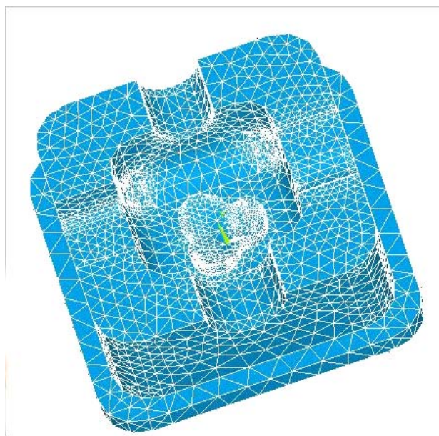
Figura 40 - Malha de elementos finitos dado 3D
