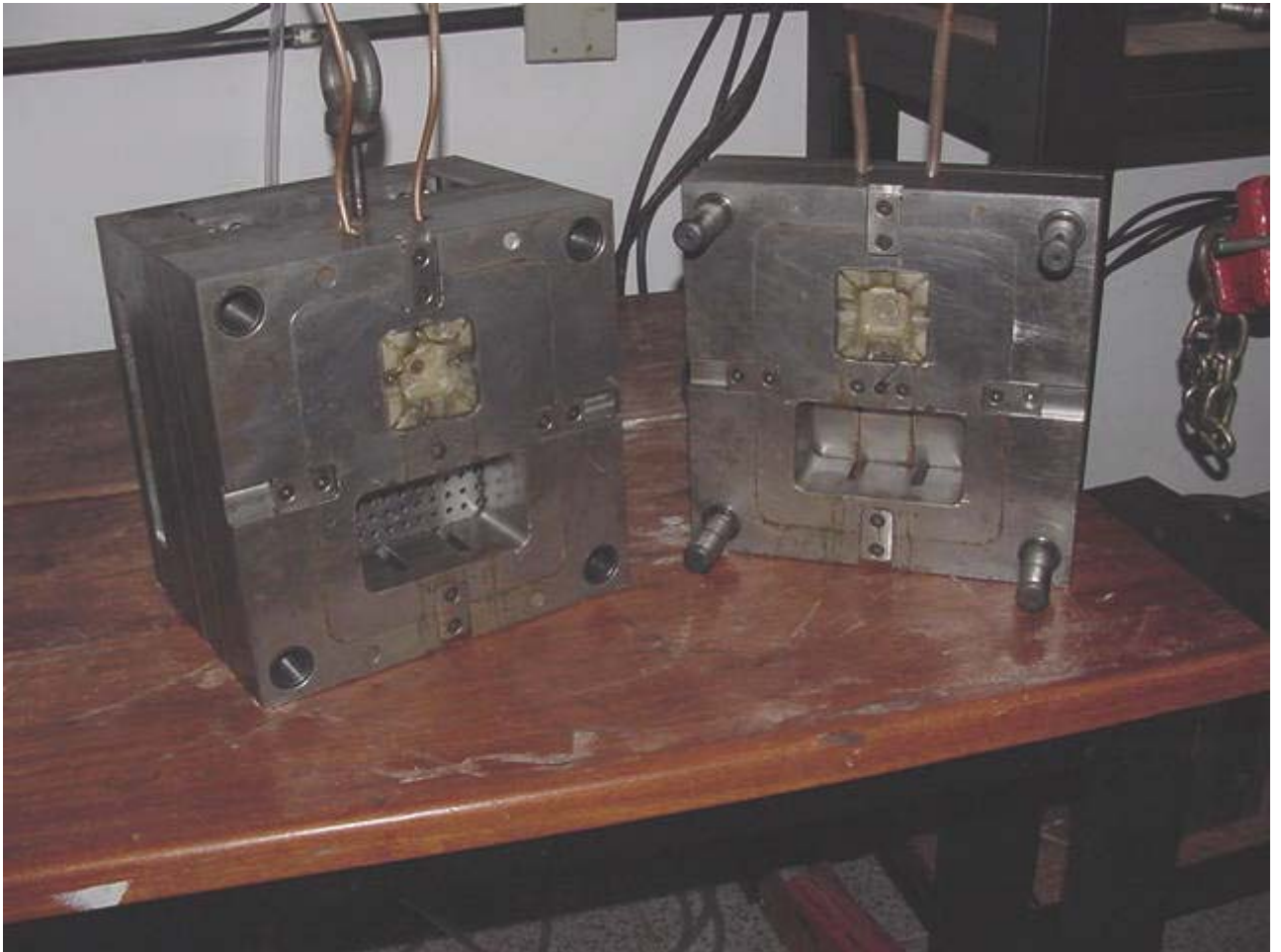
Figura 13 - Insertos fabricados por "Direct Aim®" em um porta moldes
