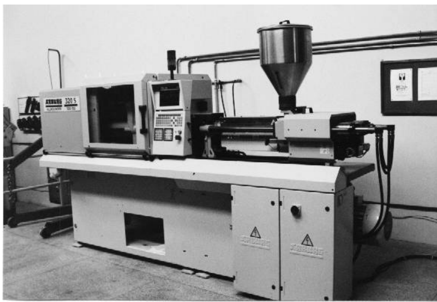
Figura 55 - Máquina injetora empregada nos estudos - Arburg 320-S
