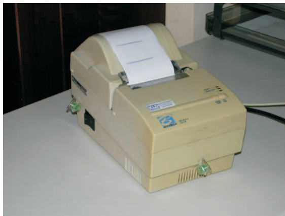
Figura 3.6: Emissor de Cupom Fiscal - ECF - É a nova máquina destinada a controlar as vendas a consumidor de determinado tipo de estabelecimentos, e que possui dispositivos de segurança eletrônicos que visam inibir a sonegação fiscal.
