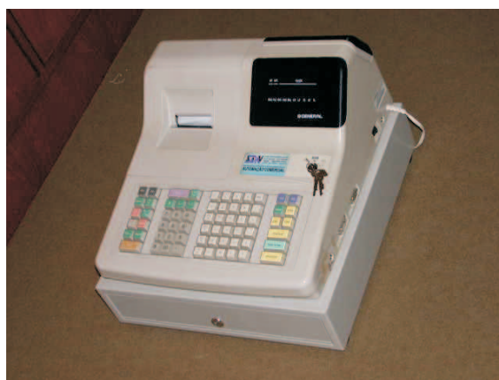
Figura 3.4: Máquina Registradora - Modelo acoplado a uma gaveta para guarda do dinheiro proveniente das vendas. Ela serve para registrar as vendas em uma fita de papel, que quando cercada dos cuidados legais, chama-se cupom fiscal.
