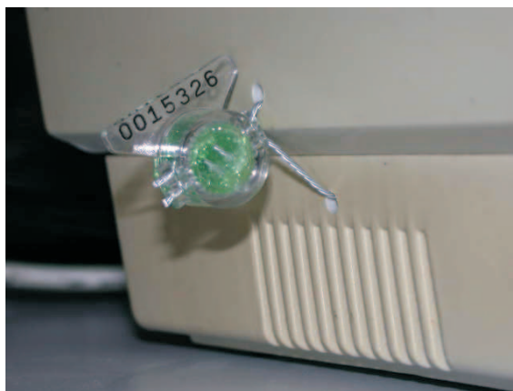
Figura 3.5: Lacre de Máquina Emissora de Cupom Fiscal - ECF - Detalhe de lacre numerado instituído com o objetivo de impedir a abertura de máquinas registradoras ou emissoras de cupom fiscal por terceiros não autorizados pelo Fisco.
