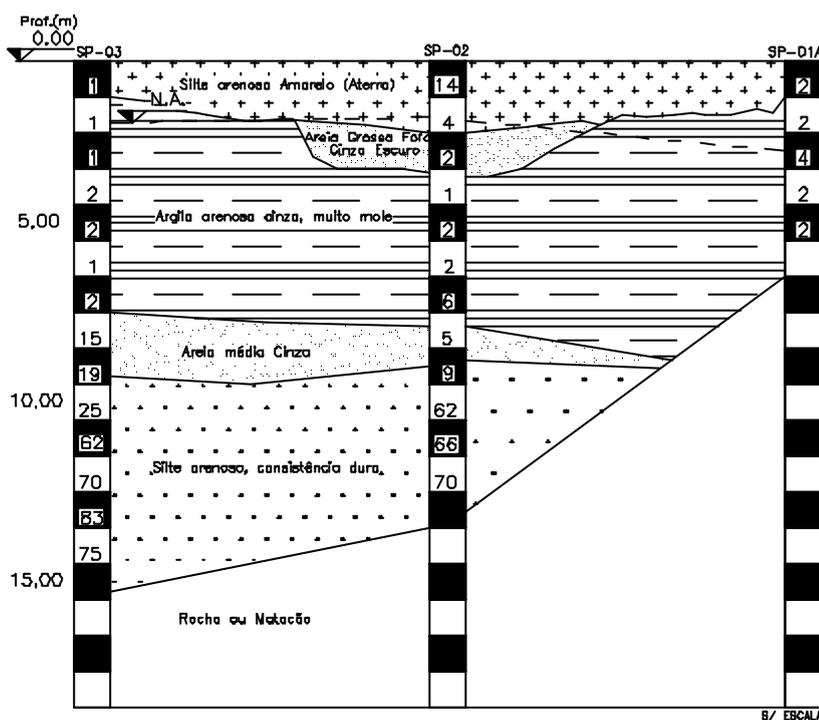
Figura 22 - Perfil de Sondagem à Percussão, corte 1-2.
