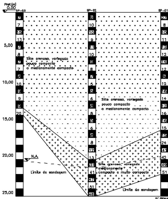
Figura 24 - Perfil de Sondagem à Percussão, corte 1-2.
