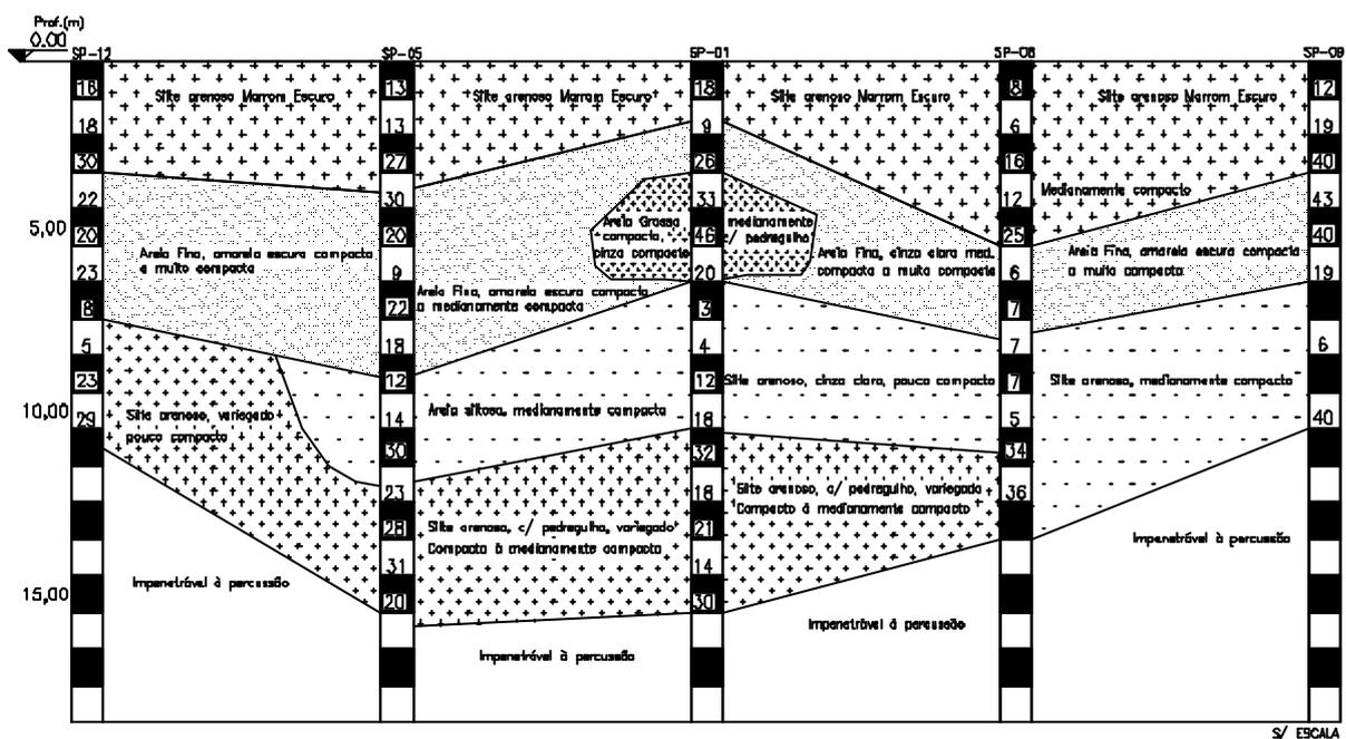
Figura 27 - Perfil de Sondagem à Percussão, corte 1-2.
