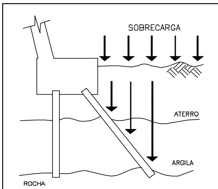
Figura 5 - Estacas inclinadas submetidas a esforços de flexão, CALAVERA (1996).
