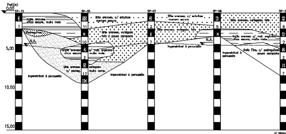
Figura 29 - Perfil de Sondagem à Percussão, corte 1-2.
